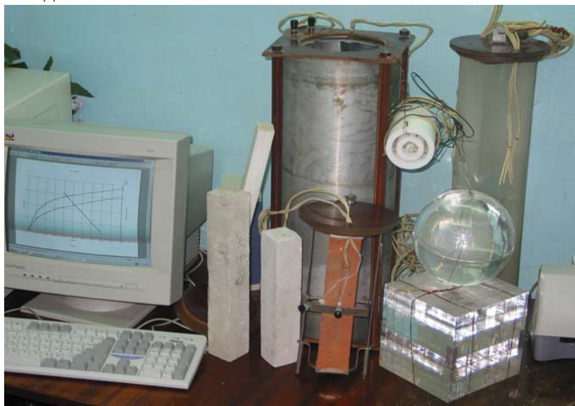
Рис. 10.4. Просмотр файла на ЭВМ при определении температуропроводности красного кирпича в графическом виде
