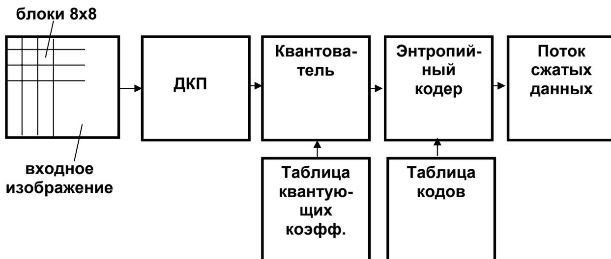
Рисунок 4.1 Схема кодера при кодировании по стандарту *JPEG*
