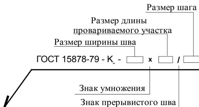
Рис. 23. Структура обозначения контактного шовного шва.
