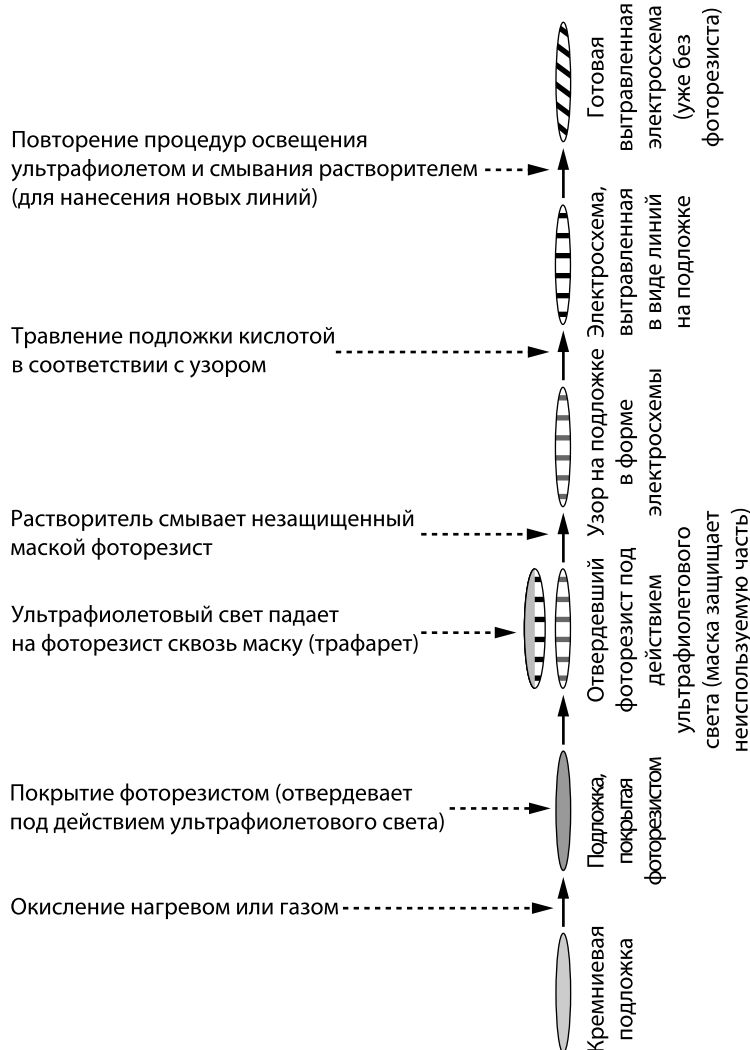
Рис. 9.2. Создание микрочипа с помощью литографии
