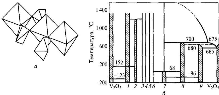
Рис. 3.5. Структура оксида V<sub>3</sub>O<sub>7</sub> (а); фрагмент фазовой диаграммы (б) системы V<sub>2</sub>O<sub>3</sub>—V<sub>2</sub>O<sub>5</sub>:
