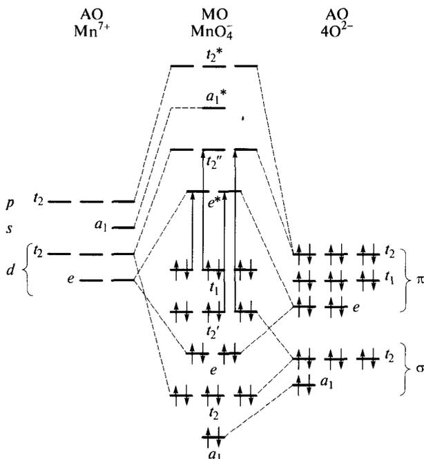
Рис. 1.37. Энергетическая диаграмма тетраэдрического иона  $\text{MnO}_4^-$  с  $\pi$ -связыванием (переходы электронов показаны стрелками)
