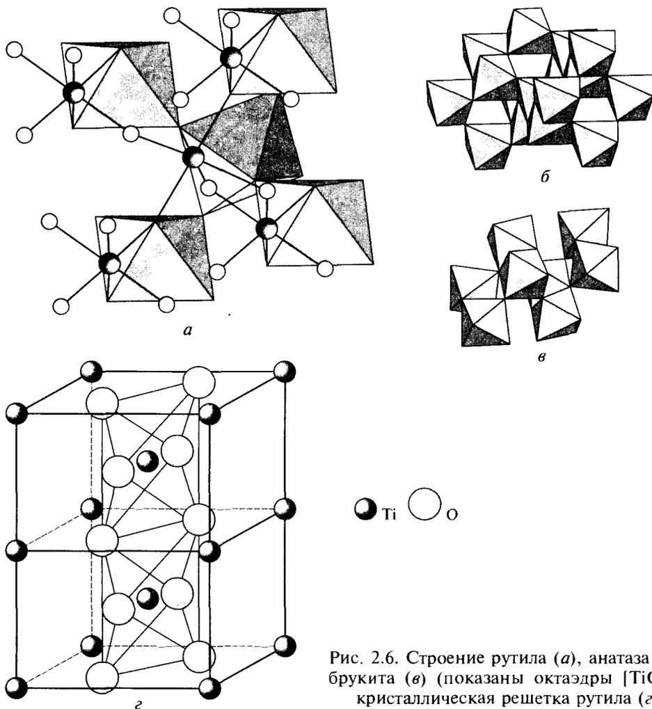
Рис. 2.6. Строение рутила (*а*), анатаза (*б*), брукита (*в*) (показаны октаэдры  $[\text{TiO}_6]$ ); кристаллическая решетка рутила (*г*)
