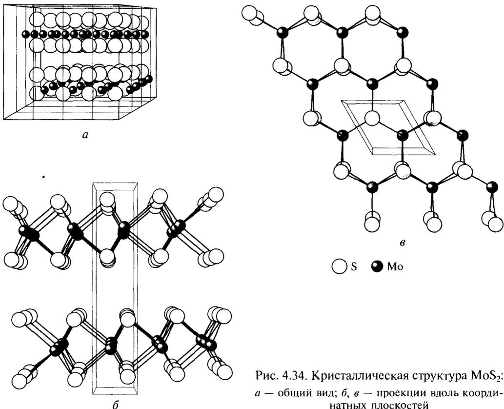
Рис. 4.34. Кристаллическая структура  $\text{MoS}_2$ :
