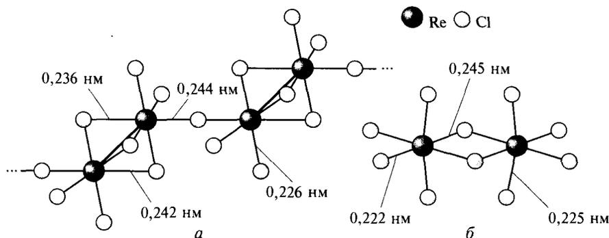
Рис. 5.45. Структура тетрахлорида (а) и пентахлорида (б) рения
