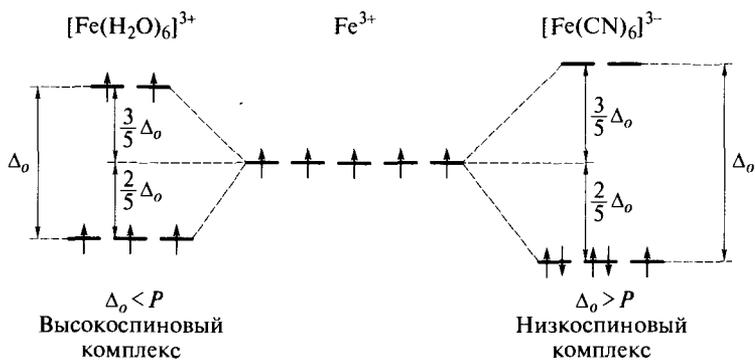
Рис. 1.25. Схема образования высокоспинового и низкоспинового комплексов
