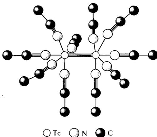
Рис. 5.22. Строение комплекса  $[Tc_2(CH_3CN)_{10}]^{4+}$  (атомы водорода не показаны)
