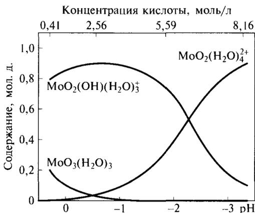
Рис. 4.24. Содержание различных катионных форм молибдена в сильнокислых растворах (без учета димеров)
