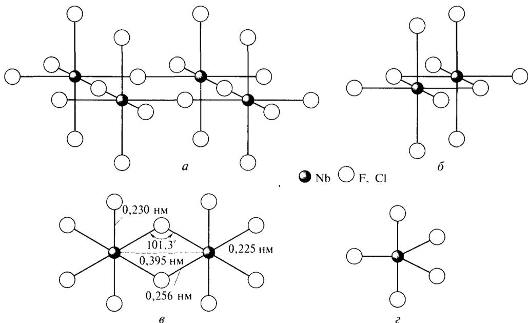
Рис. 3.28. Пентагалогениды ниобия: строение кристаллов  $\text{NbF}_5$  (а) и  $\text{NbCl}_5$  (б); длины связей и валентные углы в димере  $\text{Nb}_2\text{Cl}_{10}$  (е); мономерная молекула  $\text{NbCl}_5$  в паре (z)
