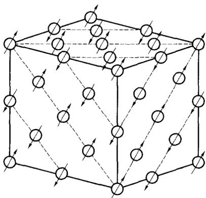
Рис. 5.11. Расположение магнитных моментов ионов  $Mn^{2+}$  в решетке  $MnO$  при температуре ниже температуры Нееля
