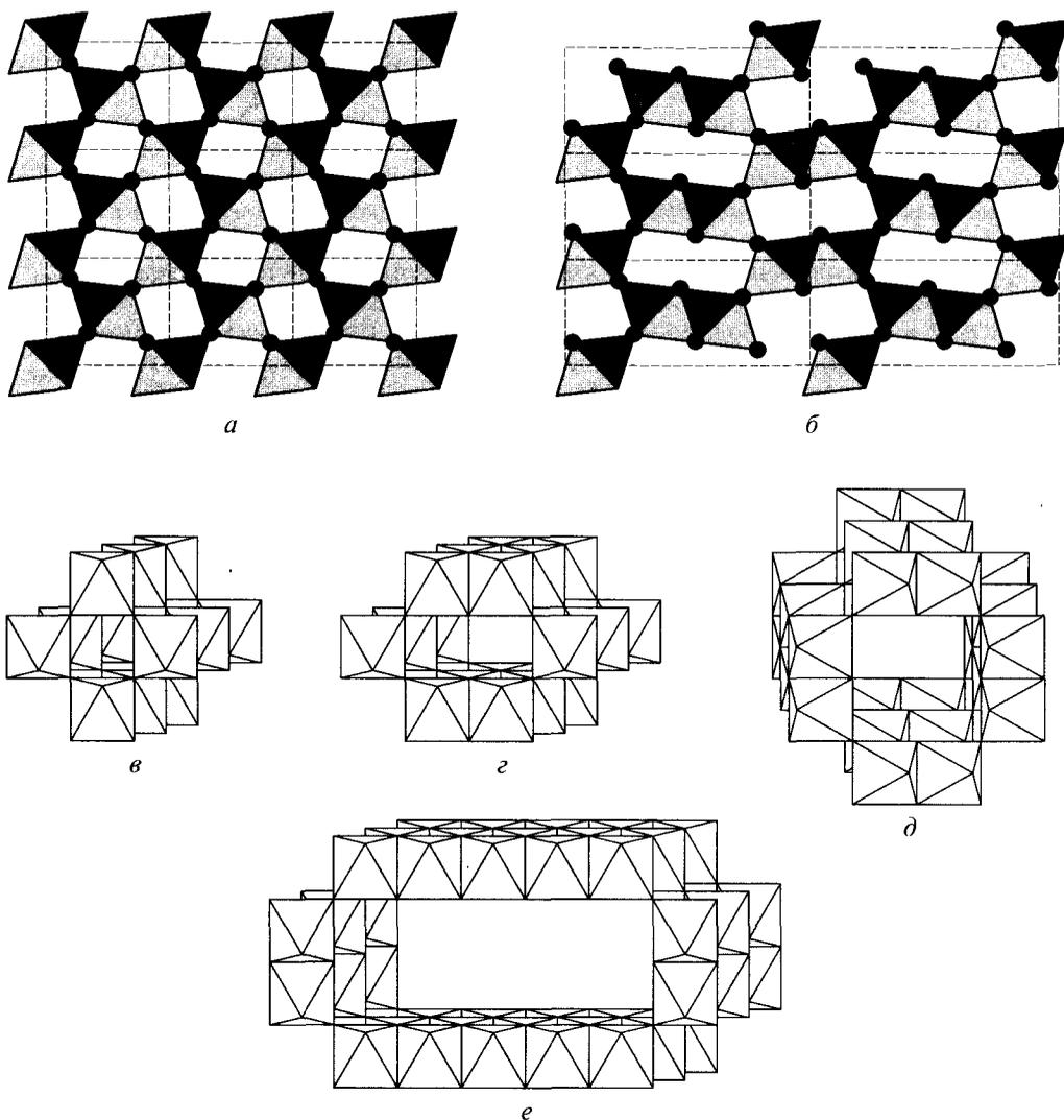
Рис. 5.16. Кристаллическая структура пиролюзита (а) и рамсделлита (б); каналы в структурах пиролюзита (в), рамсделлита (г), криптомелана (д) и одного из псиломеланов (е)
