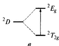
Рис. 1.35. Электромагнитная шкала (а); электронный спектр иона  $[\text{Ti}(\text{H}_2\text{O})_6]^{3+}$  (б); расщепление термина  ${}^2D$  (в) (переход электрона, вызывающий окраску, показан стрелкой)
