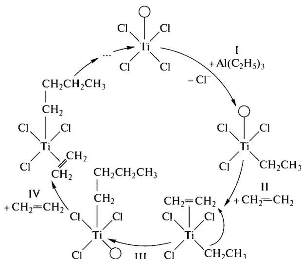
Рис. 2.18. Схема полимеризации этилена на катализаторе Циглера—Натта
