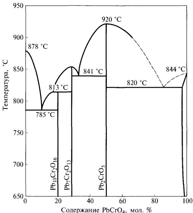
Рис. 4.17. Фазовая диаграмма системы  $\text{PbCrO}_4$ — $\text{PbO}$  (с упрощениями)
