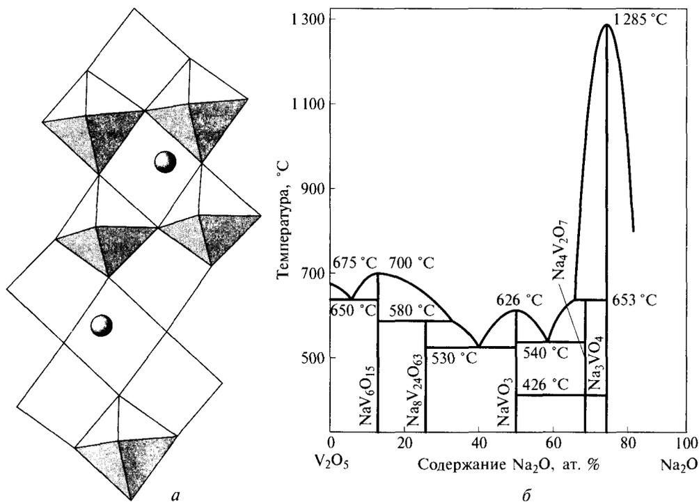
Рис. 3.22. Структура ванадиевой бронзы (а) (атомы Na расположены между слоями из пирамид  $[VO_5]$  в структуре  $V_2O_5$ ); фазовая диаграмма системы  $V_2O_5 - Na_2O$  (б) (изотерма при  $426^\circ C$  показывает полиморфный переход в  $Na_4V_2O_7$ )
