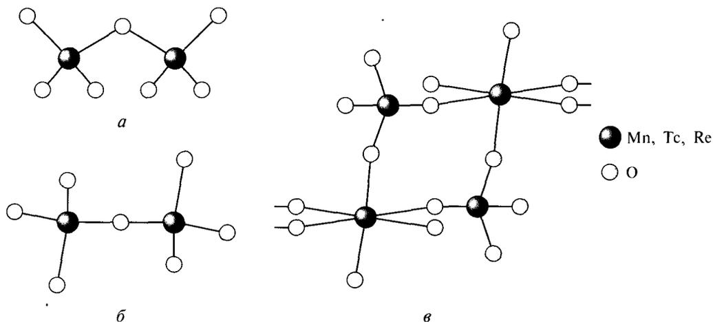
Рис. 5.19. Структура высших оксидов марганца (а), технеция (б), рения (в)
