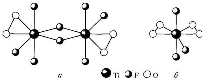
Рис. 2.16. Строение пероксоанионов титана(IV) в комплексах  $K_4[Ti_2F_8(O_2)_2] \cdot H_2O$  (а);  $K_3[TiF_3(O_2)_2]$  (б)
