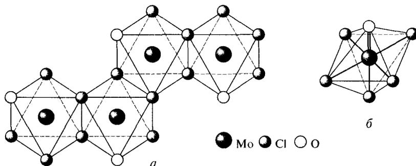
Рис. 4.32. Структура оксохлоридов MoOCl<sub>3</sub> (а), [MoOCl<sub>5</sub>]<sup>2-</sup> (б)
