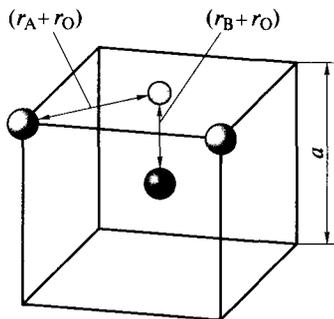
Рис. 1.20. Соотношение ионных радиусов в структуре перовскита
