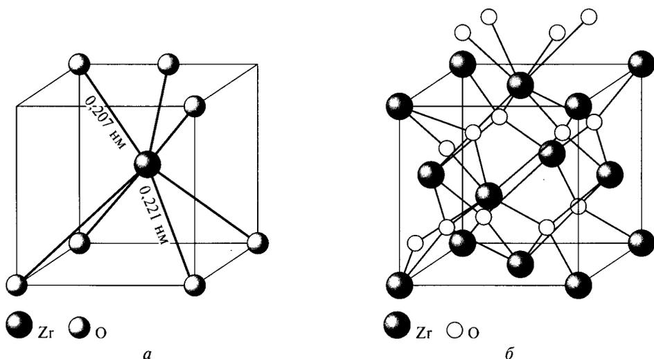
Рис. 2.7. Строение оксида  $ZrO_2$ :
