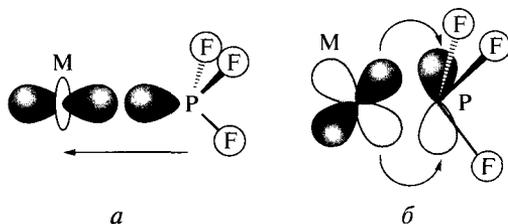
Рис. 1.8. Образование  $\sigma$ -связей (а) и  $\pi$ -связей (б) в комплексе с  $\text{PF}_3$
