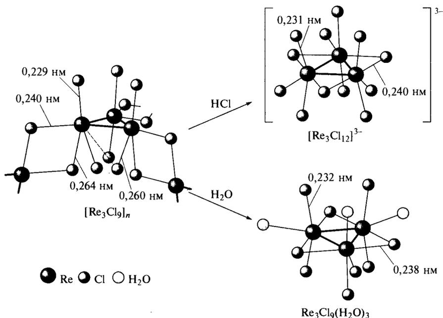
Рис. 5.43. Безводный хлорид рения(III) и продукт его гидратации
