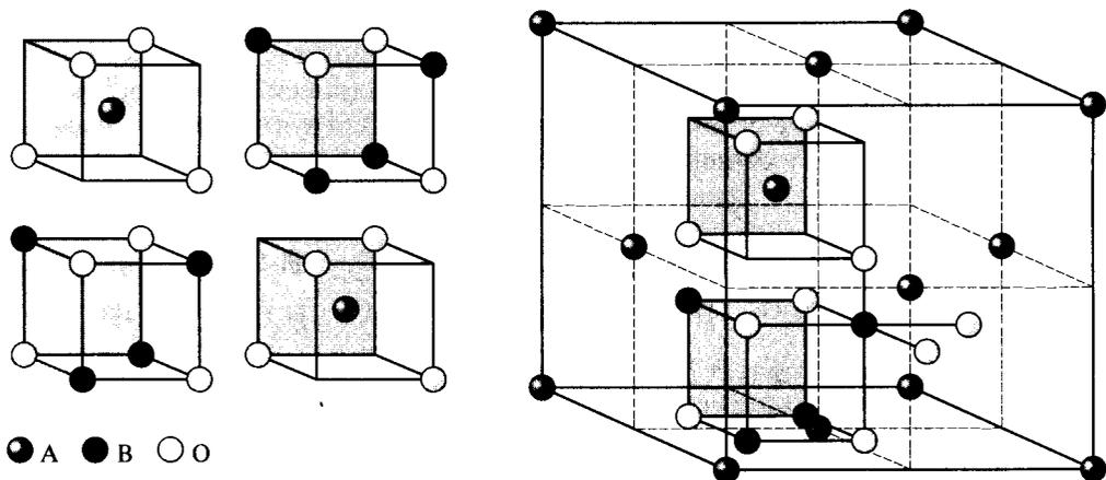
Рис. 1.21. Структура шпинели
