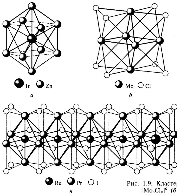
Рис. 1.9. Кластеры:  $[\text{InZn}_{10}]^-$  (а),  $[\text{Mo}_6\text{Cl}_8]^{6+}$  (б),  $\text{Pr}_4\text{Ru}_{15}$  (в)
