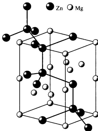
Рис. 1.15. Строение интерметаллида  $MgZn_2$  — фазы Лавеса
