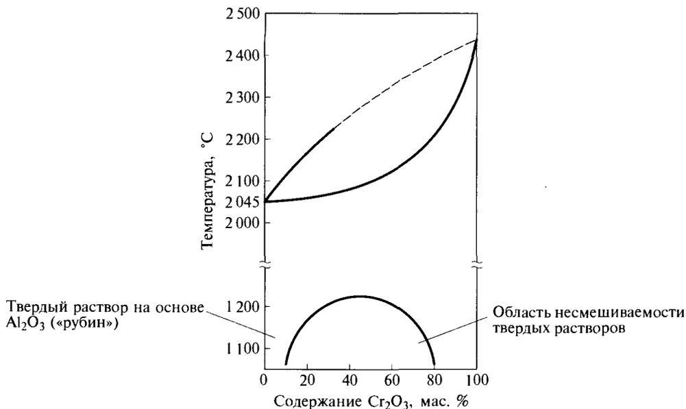
Рис. 4.3. Фазовая диаграмма системы  $\text{Cr}_2\text{O}_3$ — $\text{Al}_2\text{O}_3$
