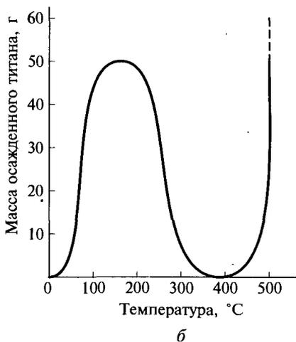
Рис. 2.3. Схема реактора (а) для иодидного рафинирования титана (1 — подвод тока; 2 — трубка для ввода титановой губки и иода; 3 — стенка сосуда; 4 — нагреваемая проволока; 5 — решетка для поддержания титановой губки; 6 — вакуумный вывод); зависимость скорости осаждения титана на вольфрамовой нити от температуры реактора (б)
