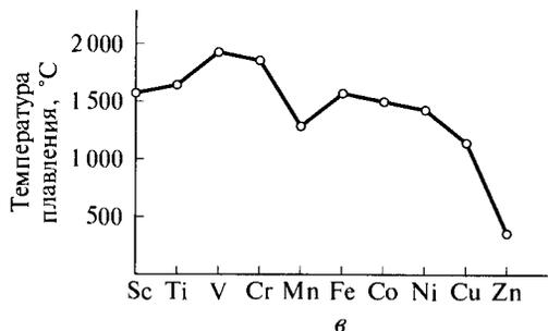
Рис. 1.13. Перекрытие  $d$ -орбиталей с образованием энергетической зоны (а); энтальпии атомизации (б) и температуры плавления (в)  $3d$ -металлов
