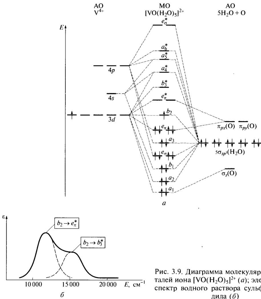
Рис. 3.9. Диаграмма молекулярных орбиталей иона  $[\text{VO}(\text{H}_2\text{O})_5]^{2+}$  (а); электронный спектр водного раствора сульфата ванадила (б)
