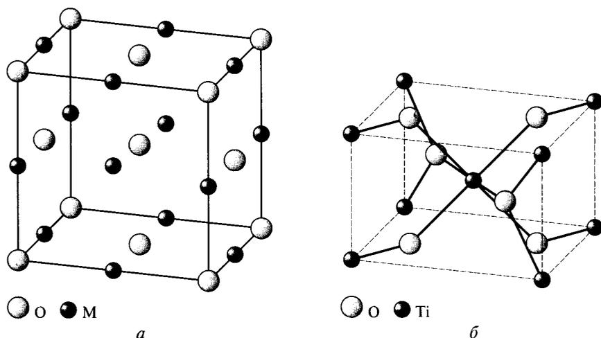
Рис. 1.16. Структура хлорида натрия (галита) (*a*) и рутила (*б*)
