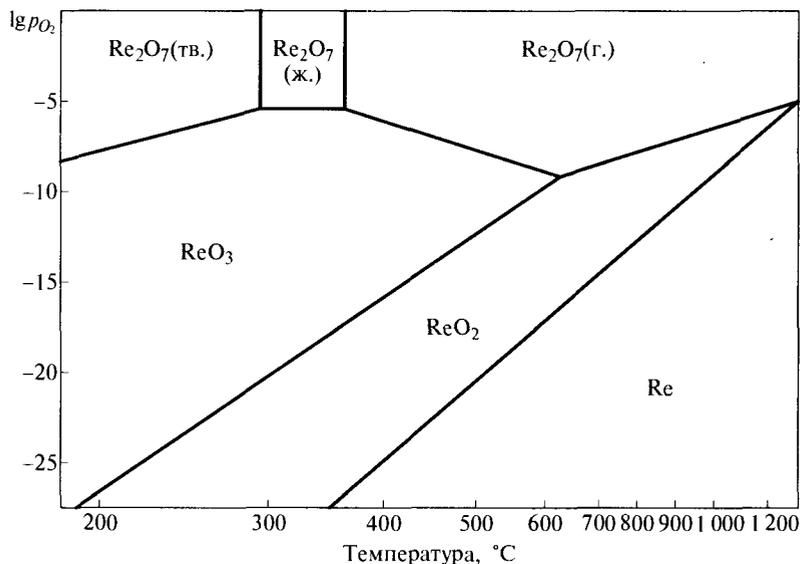
Рис. 5.9. Продукты окисления рения кислородом при разных значениях температуры и парциального давления кислорода ( $p_{O_2}$ , атм)
