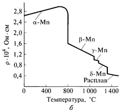
Рис. 5.6. Последовательность фазовых переходов марганца в зависимости от давления и температуры (а); зависимость электрического сопротивления ( $\rho$ ) марганца от температуры (б)
