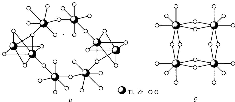
Рис. 2.10. Строение катионов оксо- и гидроксоослей, образующихся при гидролизе тетрахлоридов титана  $[\text{Ti}_8\text{O}_{12}(\text{H}_2\text{O})_{24}]^{8+}$  (а) и циркония  $[\text{Zr}_4(\text{OH})_8(\text{H}_2\text{O})_{16}]^{8+}$  (б)
