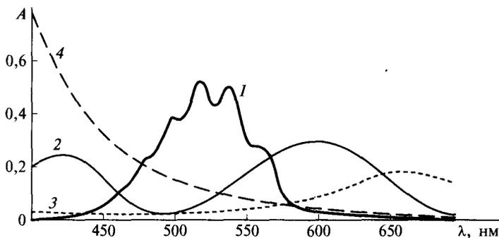
Рис. 5.36. Электронные спектры поглощения раствора перманганата калия (1) и продуктов его восстановления, включая промежуточные соединения:  $\text{MnO}_4^{2-}$  (2),  $\text{MnO}_4^{3-}$  (3),  $\text{MnO}_2 \cdot \text{aq}$  (коллоидный раствор) (4) — при температуре 20 °С (концентрация раствора 0,2 ммоль/л)
