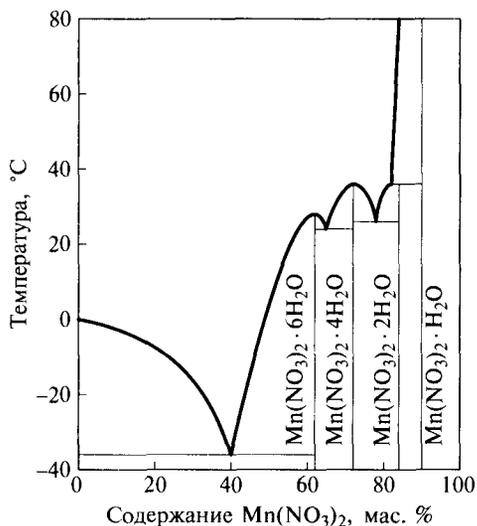
Рис. 5.21. Фазовая диаграмма системы Mn(NO<sub>3</sub>)<sub>2</sub>—H<sub>2</sub>O
