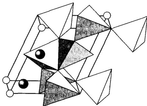
Рис. 5.20. Строение  $\text{K}_2\text{Mn}_2\text{O}_7$
