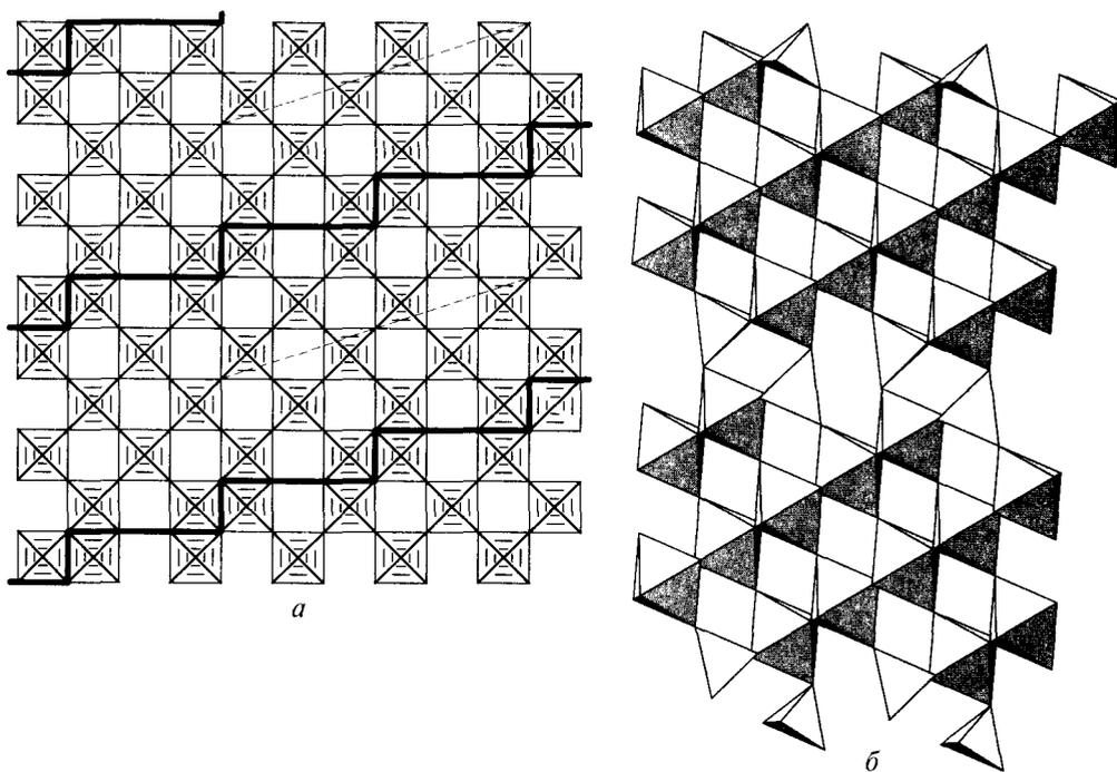
Рис. 4.5. Схематическое представление структуры  $\text{Mo}_8\text{O}_{23}$  (а) (плоскости кристаллографического сдвига, показанные жирными линиями, разделяют фрагменты со структурой типа  $\text{ReO}_3$ ; по линиям этих плоскостей находятся октаэдры  $[\text{MoO}_6]$ , соединенные гранями); строение  $\text{Mo}_4\text{O}_{11}$  (б)
