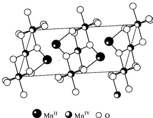
Рис. 5.15. Проекция структуры оксида  $Mn_5O_8$
