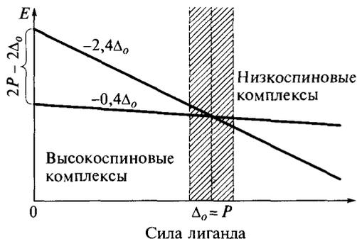
Рис. 1.27. Изменение энергии стабилизации кристаллическим полем в зависимости от силы лиганда для высокоспиновых и низкоспиновых комплексов с конфигурацией иона металла  $d^6$  (область, в которой возможно существование обоих состояний, заштрихована)
