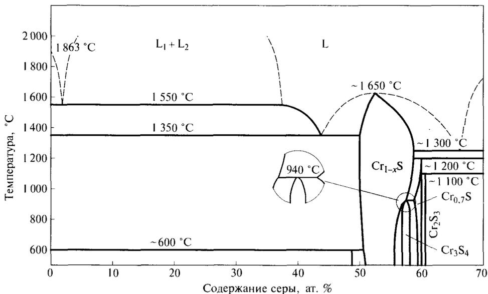
Рис. 4.33. Фазовая диаграмма системы хром — сера (темным показаны области гомогенности сульфидов  $\text{Cr}_{1-x}\text{S}$ ,  $\text{Cr}_{0.7}\text{S}$ ,  $\text{Cr}_3\text{S}_4$ ; фазы  $\text{Cr}_7\text{S}_8$  и  $\text{Cr}_5\text{S}_6$  образуются при температуре 320 и 325 °С соответственно)
