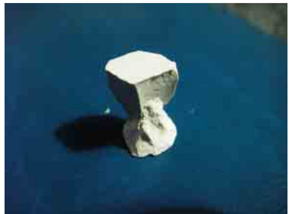
Образец биоцемента после механических испытаний
