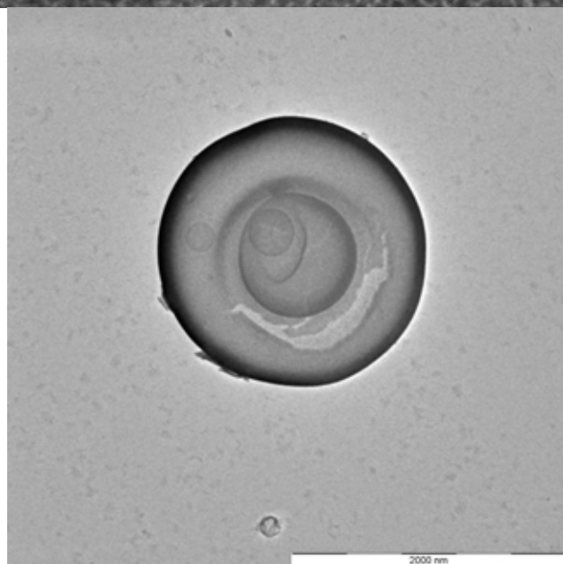
Строение оболочек полых «соляных капсул», содержащих магнитные наночастицы оксида железа (III).
