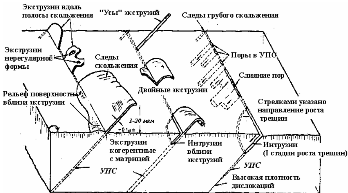
Рис. 24. Схема образования экструзий и интрузий в устойчивых полосах скольжения (УПС) при циклическом деформировании
