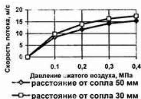
Рисунок 5.3 – Зависимость скорости потока аэрозоля от давления сжатого воздуха на входе вихревой камеры диспергатора-распылителя
