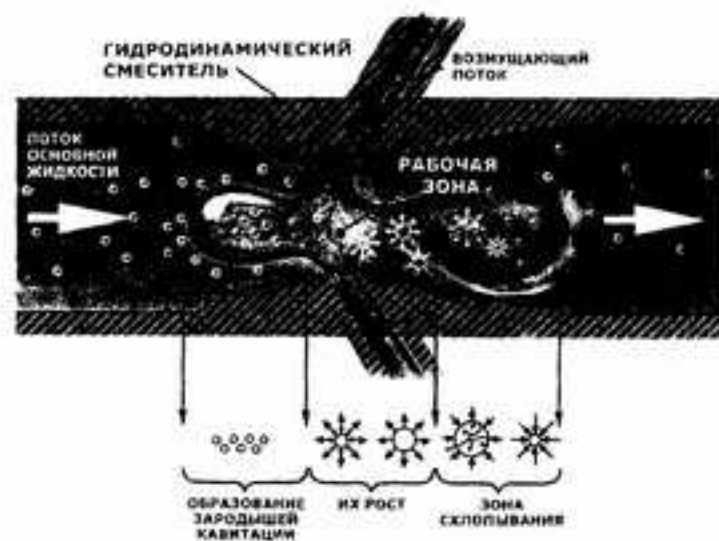
Рисунок 1.6 – Схема работы гидродинамической установки фирмы «ТЕКМАШ» (Украина)
