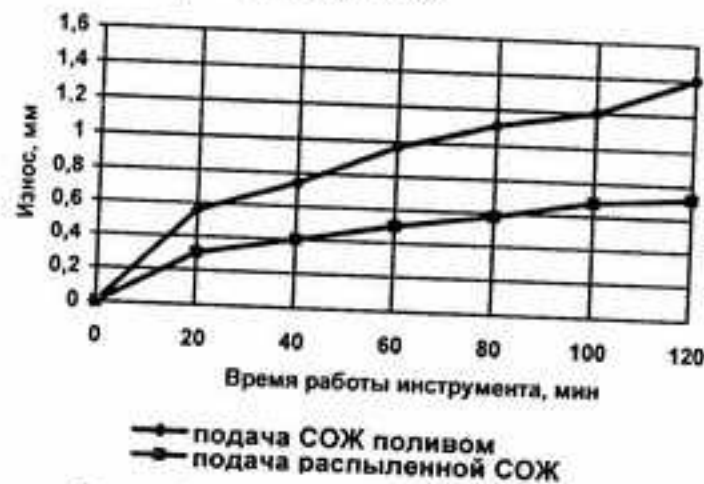
Рисунок 5.13 – Зависимость износа резца Т15К6 от времени работы при точении стали 45
