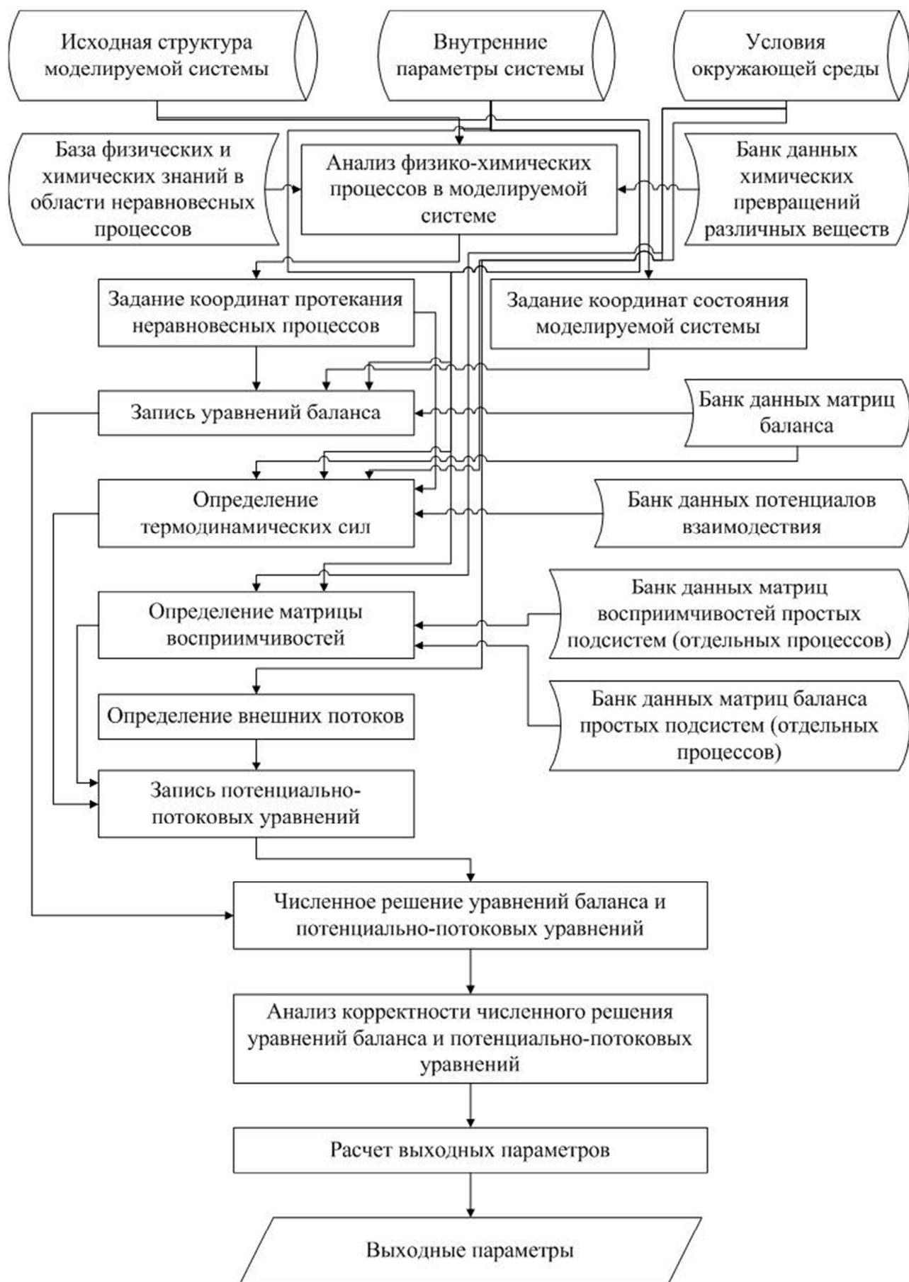
Рисунок 3.5. Формализм описания неравновесных процессов в замкнутой системе
