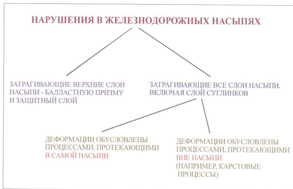
РИС. 11.2. Схема основных типов деформаций и причин, их вызывающих, в железнодорожных насыпях по данным георадиолокационных исследований
