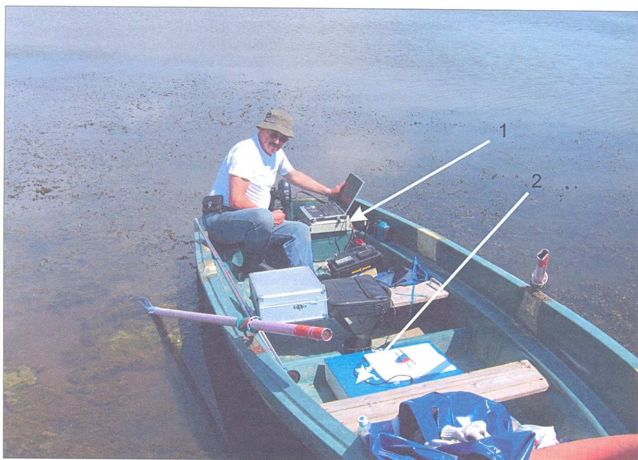
РИС. 10.1. Георадиолокационные исследования с пластиковой лодки.
