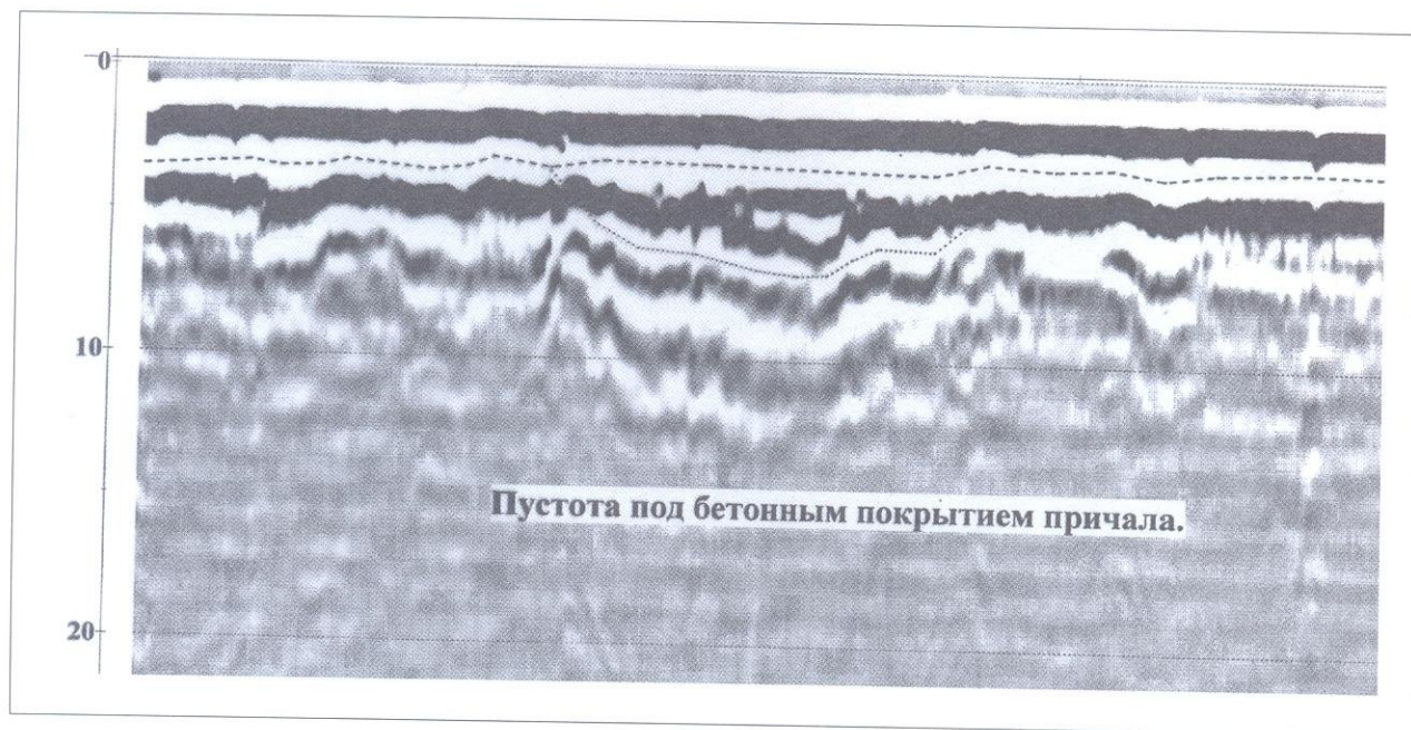
РИС. 13.12. Цель исследований — определение пустот под бетонным покрытием причала. Нижняя пунктирная линия показывает глубину провала. Максимальная глубина провала составляет около 4 наносекунд двойного времени (около 60 см при V=30 см/нс). Антенна 1 ГГц, георадар «Зонд 12»
