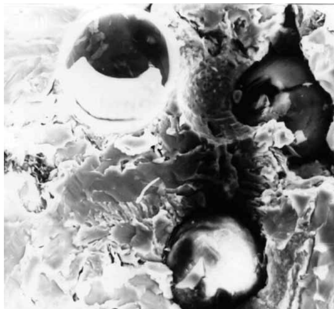
Рис. 12.2. Рабочая поверхность алмазного круга на металлической связке с корундовыми микросферами
