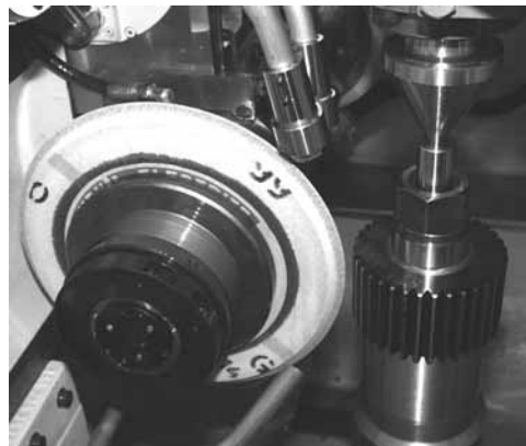
Рис. 7.8. Профилирование зубчатого колеса на станке мод. Р400G
