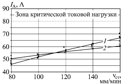
Рис. 9.13. Зависимость токовой нагрузки от скорости подачи при глубинном шлифовании хвостовика лопаток ГТД высокопористыми кругами: 1 – 89A 100 2G 11 A V237 P25; 2 – 99BA 100 G 12 V
