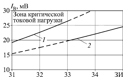
Рис. 9.6. Токовая нагрузка при глубинном шлифовании сплава ЖС6У высокопористыми кругами с характеристикой: 1 – 25А 12П ВМ2 12 К5 КФ40; 2 – 99ВА 100 G 12 V
