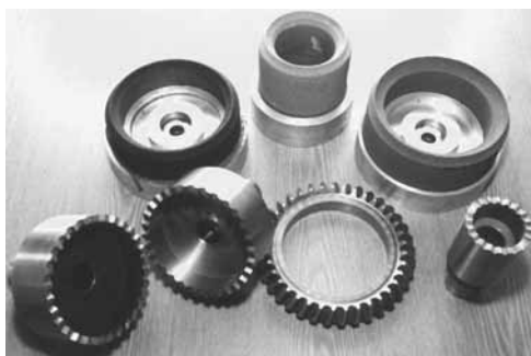
Рис. 7.14. Обработанные детали с профилем Курвик и высокопористые абразивные круги кольцевого профиля
