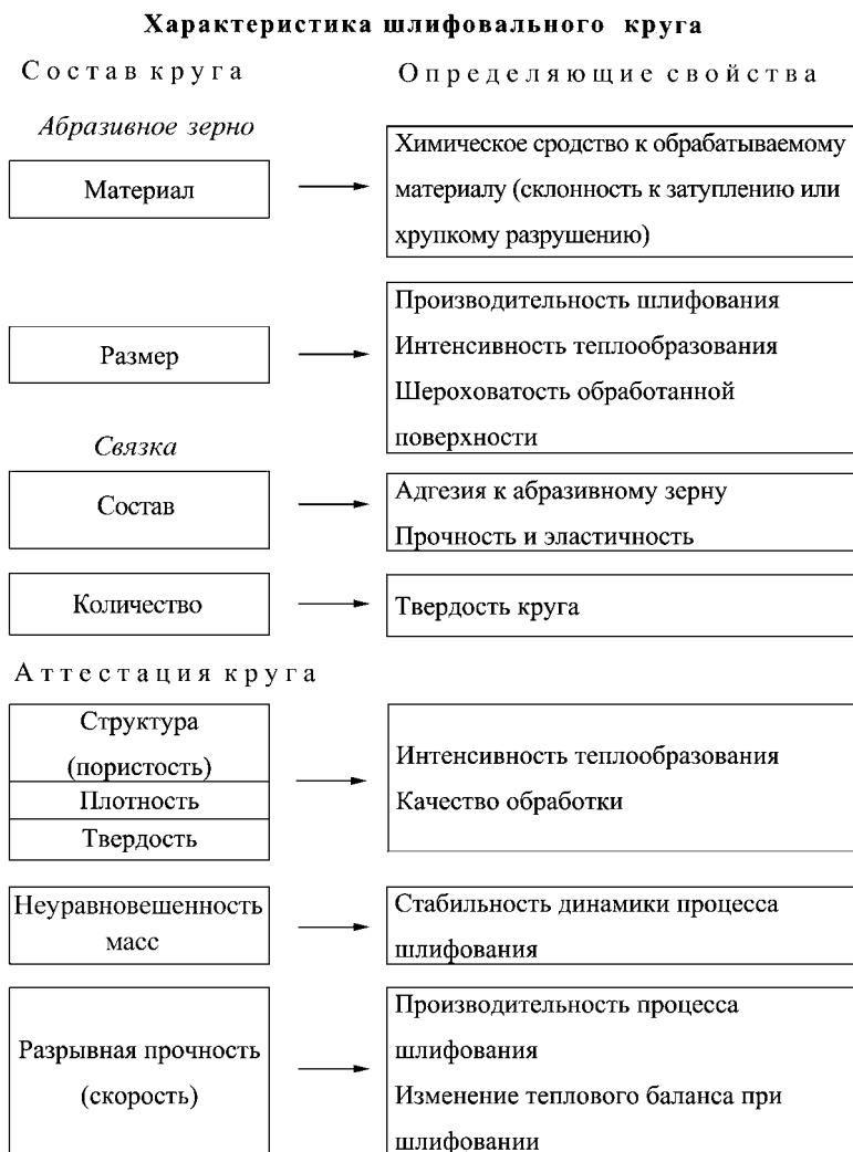
Рис. 13.1. Влияние состава и свойств шлифовального круга на характеристики процесса шлифования
