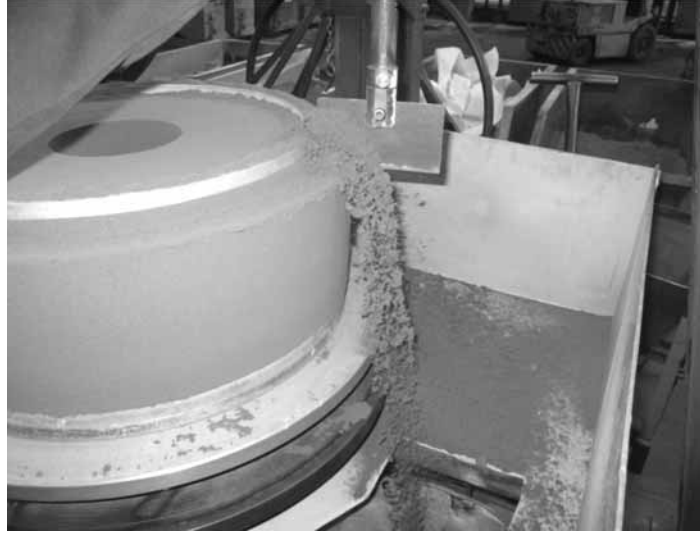
Рис. 4.6. Предварительное обтачивание заформованной заготовки шлифовального круга
