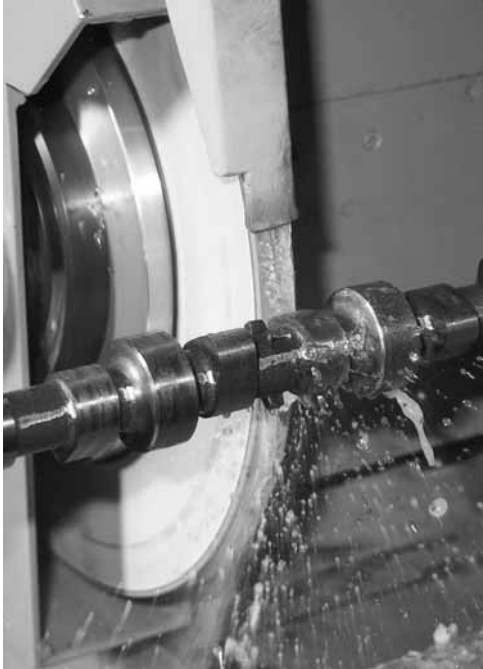
Рис. 12.19. Обработка кулачков распределительного вала кругом из кубического нитрида бора (фото фирмы Krebs&Riedel)
