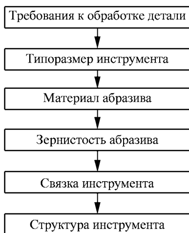
Рис. 13.6. Алгоритм назначения параметров абразивного шлифовального круга
