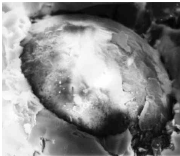
Рис. 3.1. Корундовая микросфера на поверхности алмазного круга на металлической связке. \times 1500
