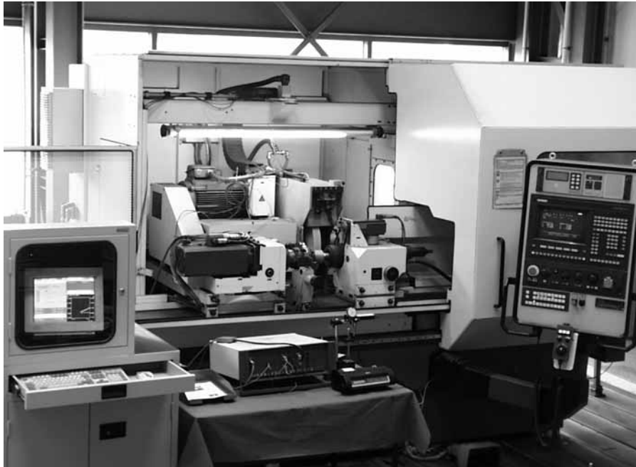
Рис. 8.10. Экспериментальная установка для сухого шлифования
