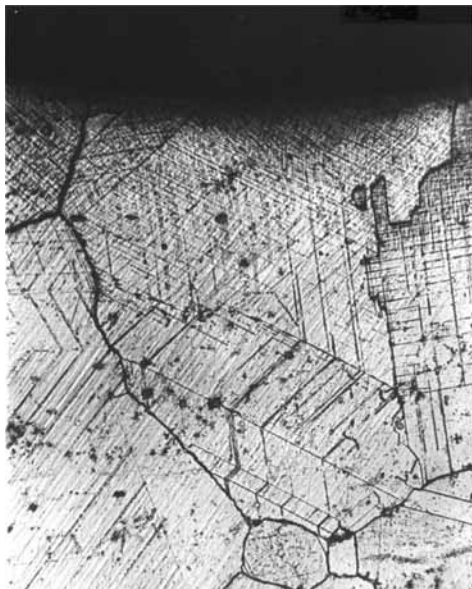
Рис. 2.21. Дислокационная структура сплава ХН77ТЮР после шлифования
