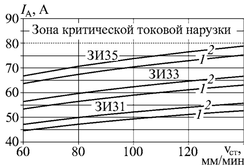
Рис. 9.11. Зависимость токовой нагрузки от скорости подачи стола при глубинном шлифовании сплавов: 1 – ЖС-32; 2 – ЖС-6У
