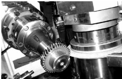
Рис. 12.22. Профильное шлифование зубчатого колеса на станке модели КХ-1 фирмы Карр
