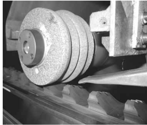
Рис. 6.14. Профильное шлифование протяжки кругом из микрокристаллического корунда
