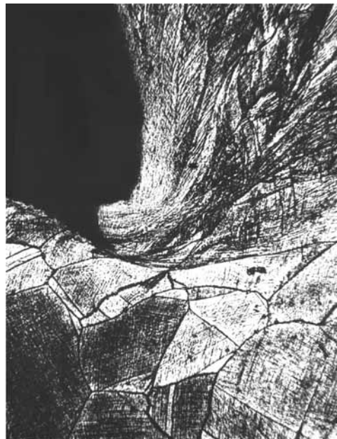
2.23. Трещина разрушения при резании сплава ХН77ТЮР. \times 800
