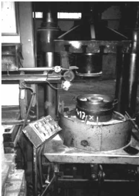
Рис. 4.4. Тележка с вращающейся пресс-формой \varnothing 500 мм для пресса с усилием 500 т
