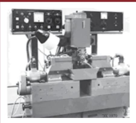
Рис. 163. Комбинированный электроискровой комплекс ЭХ1970 с СЧПУ 15ИПЧ-3-001 для изготовления пролетных каналов малого диаметра многолучевых электронных СВЧ приборов (МЛП)
