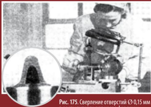
Рис. 175. Сверление отверстий  $\varnothing 0,15$  мм в распылителях для насос-форсунок на быстроходном сверлильном станке с пневматическим приводом
