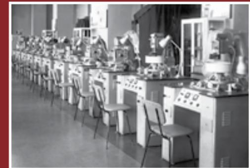
Рис. 65. Электроискровые координатные установки А207.16, созданные на базе большого инструментального микроскопа БМИ-1 для изготовления деталей методом «прошивки»
