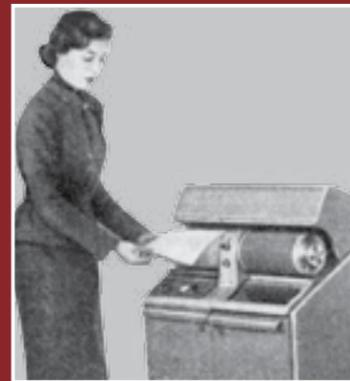
Рис. 194. Внешний вид электроискровой фотогравировальной машины «Стенофакс»
