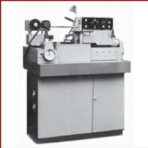
Рис. 168. Станочный модуль 04 ИВ-200 со встроенным генератором импульсов. Занимаемая площадь — 1,2 м<sup>2</sup>
