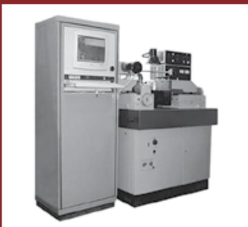
Рис. 169. Электроискровой комплекс «Элиур 2-200» модели А207.92М со встроенным генератором импульсов и управлением по двум осям с СЧПУ на базе компьютера
