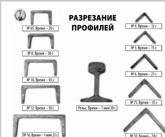
Рис. 10. Электроискровое разрезание сортового проката дисковой пилой
