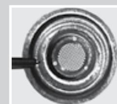
Рис. 15. Сетка  $\varnothing 4,5$  мм: 152 квадратных отверстия  $0,25 \times 0,25$  мм. Ширина перемычек 30 мкм
