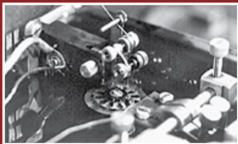
Рис. 71. Изготовление медной проволокой Ø 0,15 мм твердосплавной матрицы вырубного штампа
