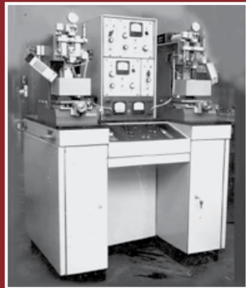
Рис. 130. Двухпозиционная установка А 207.91 для прорезания пролетных каналов (шириной 20–25 мкм) для замедляющих систем ЛОВ субмиллиметрового диапазона длин волн
