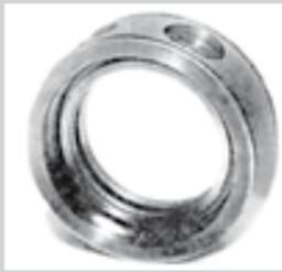
Рис. 67б. Деталь, изготовленная на установках А207.12 (А207.23) с оптическими делительными головками с использованием метода «прошивки»
