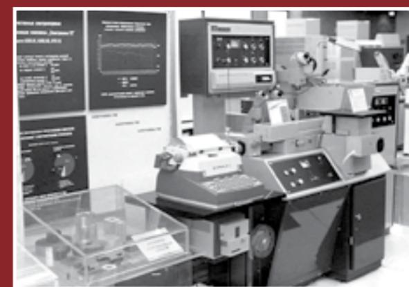
Рис. 179. Электроискровая координатная установка на базе А207.23 с тиратронным генератором импульсов и СЧПУ на выставке электронной техники в Москве
