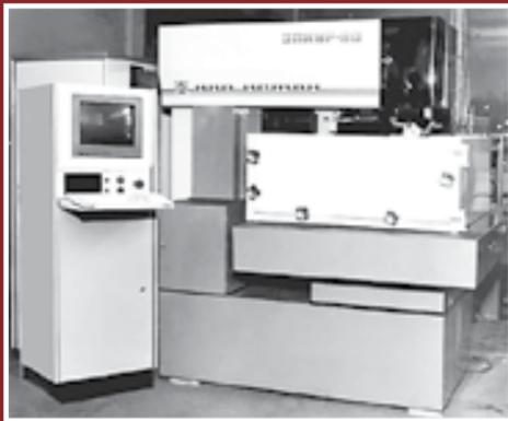
Рис. 173. Электроискровой комплекс «Элиур 90» (ЭХ 2214) с автоматической заправкой электрода-проволоки и управлением по 5 осям.
