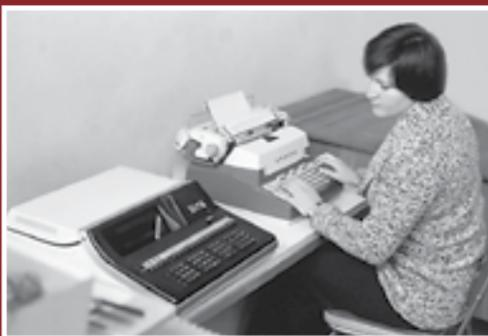
Рис. 156. Система подготовки программ на базе мини-ЭВМ «Электроника ДЗ-28»
