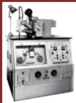
Рис. 60. Установка А207.44 со встроеным малогабаритным транзисторным генератором
