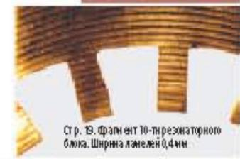
Стр. 19. Фрагмент 10-ти резонаторного блока. Шнрнна ламелей 0,4 мм
