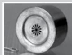
Рис. 36. 12-резонаторный анодный блок «Ромашка»:  $d = 0,5$  мм,  $D = 2,5$  мм,  $h = 6$  мм
