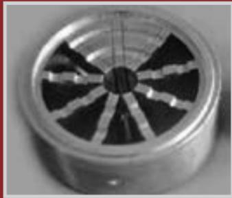
Рис. 225. Анодный блок амплитрона (макет «Салюта»). Высота — 50 мм.  $D = 62$  мм,  $d = 14$  мм. Ламели — 4 мм. Вырезано 7 резонаторов.
