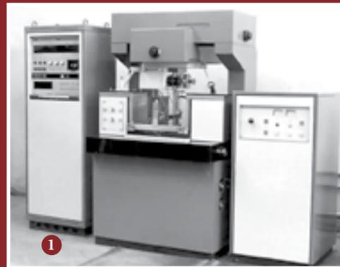
Рис. 158. Электроискровой комплекс А207.79 с ЧПУ 15ИПЧ-3-001 (1)
