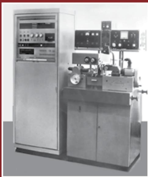
Рис. 162. Электроискровой комплекс 04IB-100 модели А207.90 для изготовления деталей ЭВП СВЧ электродом-проволокой  $\varnothing$  6–15 мкм
