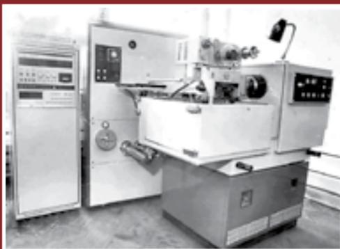
Рис. 155. Комплекс 04ИВ-400 (слева направо): 1) УЧПУ 15ИПЧ-3-001; 2) гидроагрегат; 3) станочный модуль
