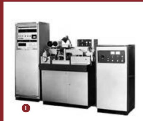
Рис. 160. Электроискровой комплекс А207.86 с ЧПУ 15ИПЧ-3-001 (1)
