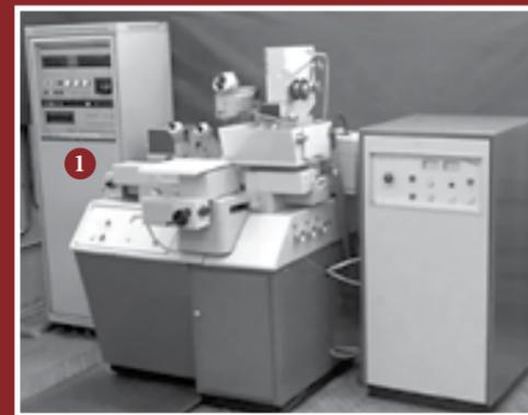
Рис. 159. Электроискровой комплекс А207.81 с ЧПУ 15ИПЧ-3-001 (1)
