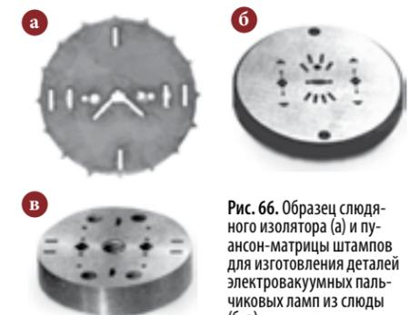
Рис. 66. Образец слядного изолятора (а) и пуансон-матрицы штампов для изготовления деталей электровакуумных пальчиковых ламп из сляды (б, в)
