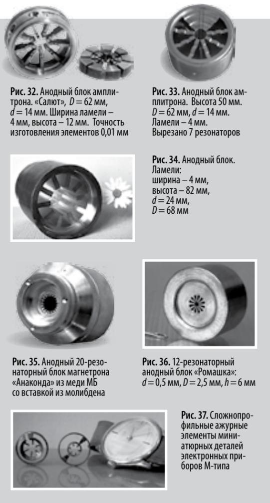
Рис. 32. Анодный блок амплитрона «Салют»,  $D = 62$  мм,  $d = 14$  мм. Ширина ламели – 4 мм, высота – 12 мм. Точность изготовления элементов 0,01 мм
