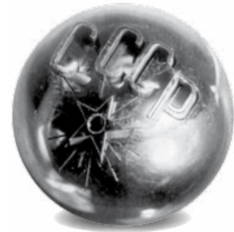
Рис. 49. Сложный рельеф, полученный на поверхности шарика подшипника  $\varnothing 24$  мм электродом-проволокой  $\varnothing 0,04$  мм
