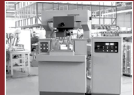
Рис. 151. Электроискровой станок 04ИВ-250 А207.80 (ОТС-2) перед отправкой в Италию
