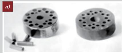
Рис. 70. Расточенные вкладыши кондукторов:
