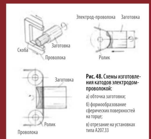
Рис. 48. Схемы изготовления катодов электродом-проволокой:
