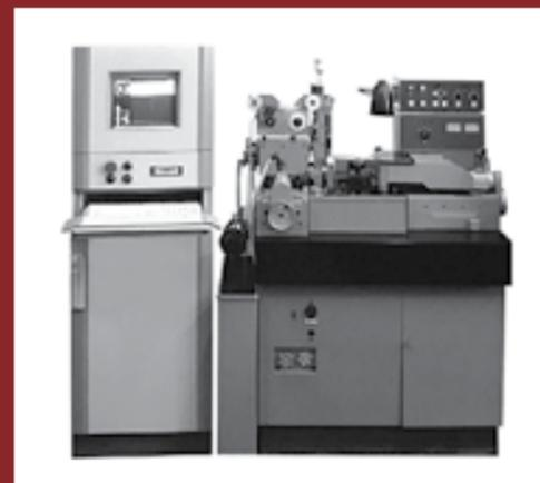
Рис. 171. Электроискровой комплекс «Элиур 5-200» модели А207.93М со встроенным генератором импульсов и управлением по 5 осям с СЧПУ на базе компьютера
