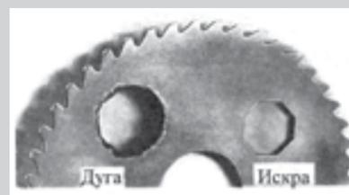
Рис. 218. Отверстия, изготовленные в закаленной стальной пластине дугowym и искровыми импульсами электрического тока
