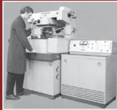
Рис. 148. Электроискровая координатная установка А207.61 с тиратронным генератором импульсов А671.45 для изготовления деталей электродом-проволокой
