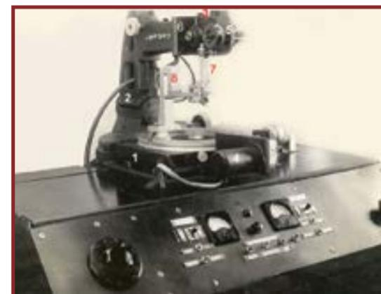
Рис. 42. Первый в мире макет электроискровой установки для вырезания анодных блоков магнетронов миллиметровых волн электродом-проволокой диаметром 30–40 мкм.
