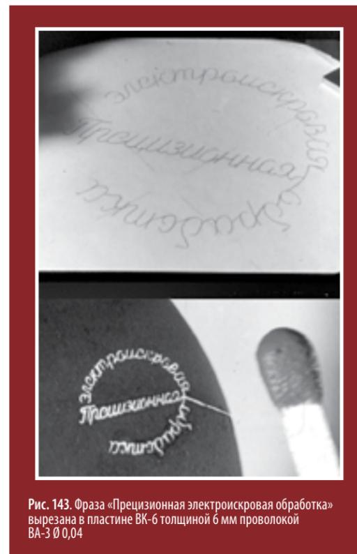
Рис. 143. Фраза «Прецизионная электроискровая обработка» вырезана в пластине ВК-6 толщиной 6 мм проволокой ВА-3 Ø 0,04
