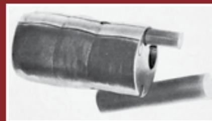
Рис. 199. Вырезание штабика  $\varnothing = 4$  мм,  $l = 30$  мм из ниобия — заготовки катода — проволокой из вольфрама на установке А207.12
