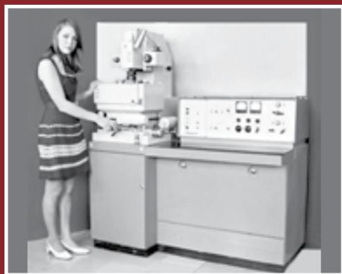
Рис. 61. Установка А207.40 со встроеным тиратронным генератором импульсов
