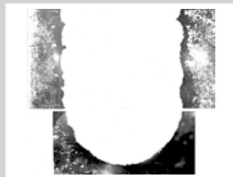
Рис. 92. Сечение паза, прорезанного в медной пластине медной проволокой Ø 0,3 мм.  $W_0 = 65000$  мкДж. Среда — вода
