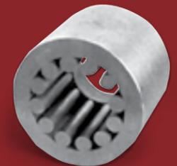
Рис. 64. Деталь, изготовленная с помощью специального комплекта электрода-инструмента, состоящего из нескольких медных пластин толщиной 4 мм
