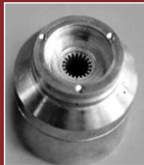
Рис. 46. Анодный блок «Анаконда» из меди со вставкой из молибдена. Внутренний диаметр 6 мм, наружный 10 мм, высота ламелей – 10 мм.
