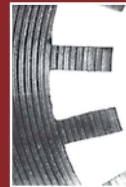
Рис. 28. Фрагмент полученного 10-резонаторного блока толщиной 4 мм ( $D = 6,7$  мм,  $d = 5,4$  мм, ширина ламели — 0,4 мм, длина — 0,82 мм)
