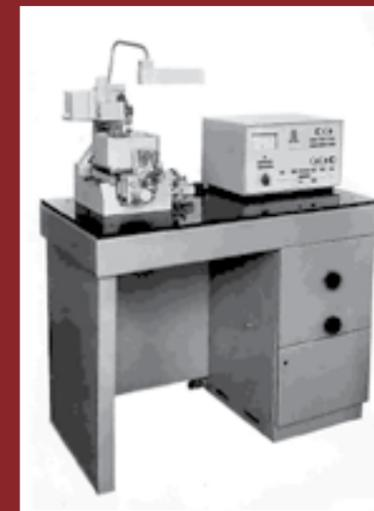
Рис. 133. Установка А 207.69 для изготовления ЗС ЛОВ субмиллиметрового диапазона волн электродом-проволокой  $\varnothing 8\text{--}12$  мкм
