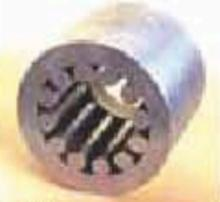
Стр. 27. Деталь, изготовленная спомощью специального комплекта электроэкс-инструмента, состоящего из нескольких медных пластин толщиной 4 мм
