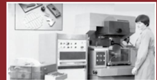
Рис. 152. Электроискровой комплекс ОТС-2 (на базе станка 04ИВ-250 А207.80) с ЧПУ фирмы Olivetti — OCN
