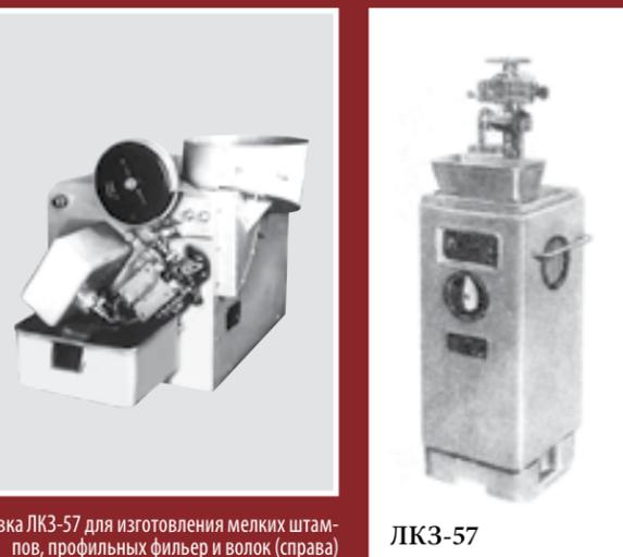
Рис. 179. Установка ЛКЗ-57 для изготовления мелких штампов, профильных фильер и волок (справа)
