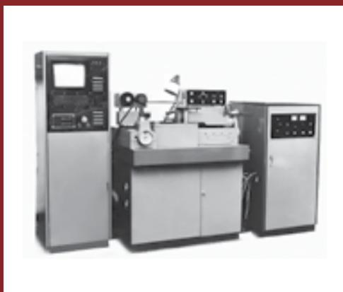
Рис. 161. Электроискровой комплекс «ЭЛИЗЕН-1» с микропроцессорным устройством ЮЦ 2.559.008
