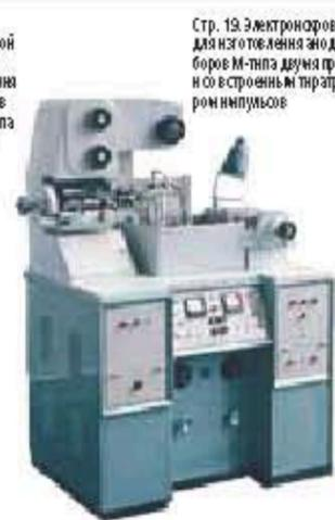
Стр. 19. Электронсоровый станок А207.27 для изготовления анодов и блочков приборов М-типа двумя проволоками и со встроенным тиристорным генератором импульсов
