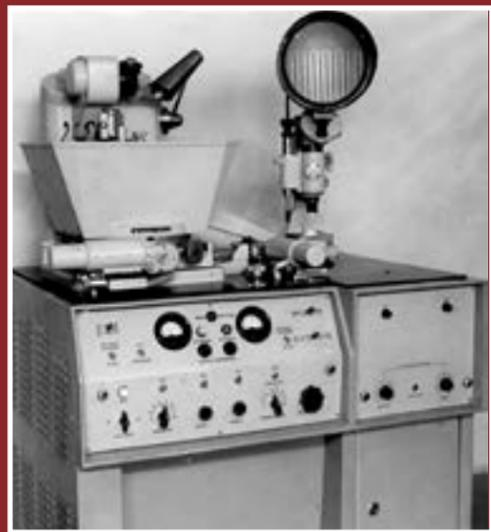
Рис. 146. Электроискровая координатная установка A.207.13/20
