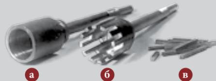
Рис. 58. Медные коронки для настройки:  $\varnothing \approx 35$  мм: а) заготовка; б) деталь; в) отходы
