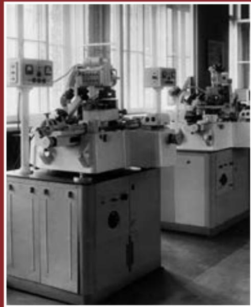
Рис. 145. Координатные установки A207.12 для изготовления деталей копированием профиля электрода-инструмента (слева) и электродом-проволокой (справа)
