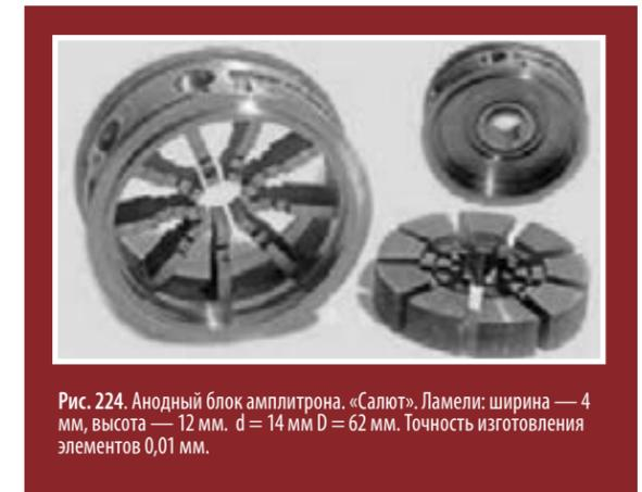
Рис. 224. Анодный блок амплитрона «Салют». Ламели: ширина — 4 мм, высота — 12 мм. d = 14 мм D = 62 мм. Точность изготовления элементов 0,01 мм.
