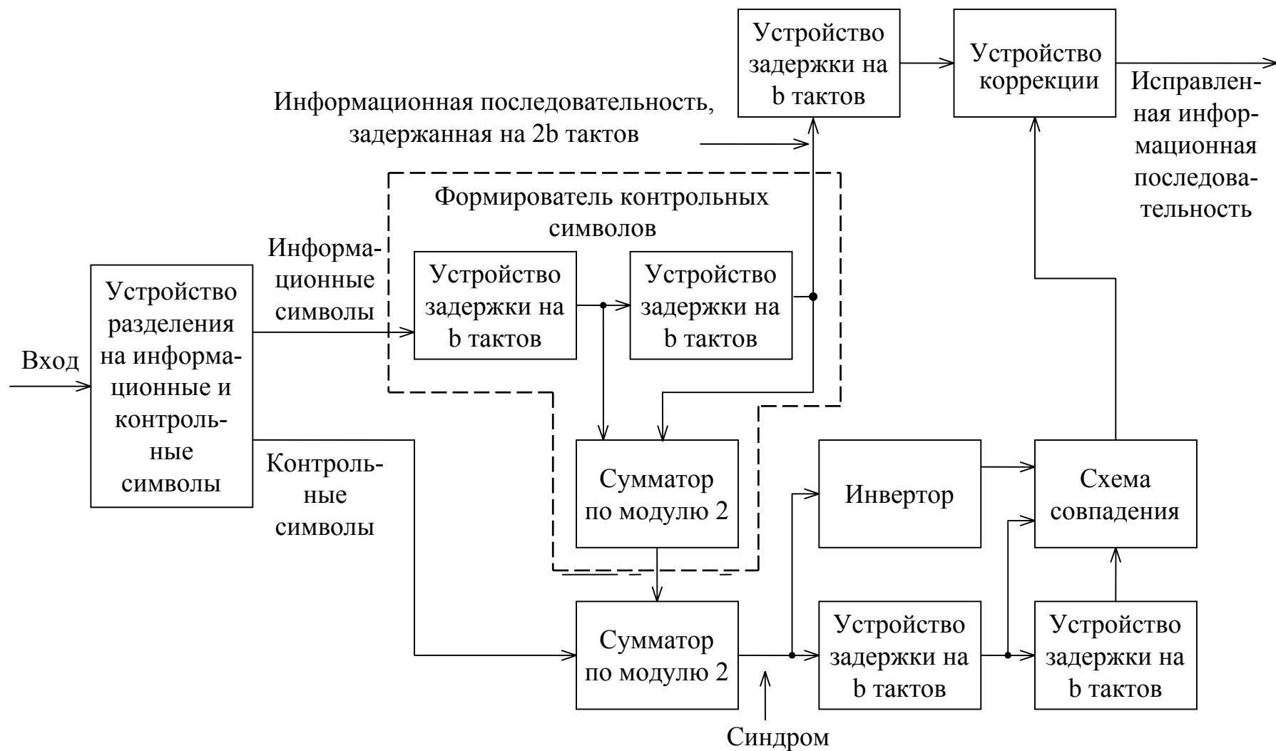
Рис. 2.9. Структурная схема декодера рекуррентного кода
