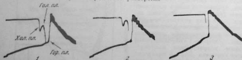
Рис. 93. Регистрации свечения при сжатии гексановоздушной смеси; \alpha = 9,3 : 1 — без светофильтра; 2 — голубой светофильтр; 3 — красный светофильтр (по Басевичу [1]).
