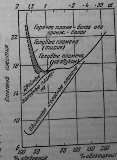
Рис. 91. Характеристики свечения при сжатии смесей n -октана с воздухом различного состава (по Даунсу, Стриту, Уэлсу [18]).
