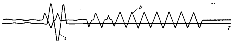
Рис. 87. Осциллограмма разрыва тока плавким предохранителем
