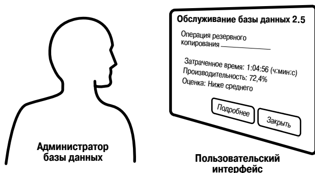
Рис. 7.3. Сообщайте значение затраченного времени, только если пользователям важно видеть, какое время потребовалось, чтобы полностью выполнить процесс. На схеме показан пример, где администратор базы данных исследует вывод программы текущего обслуживания, который информирует о том, была ли допустимой ее производительность
