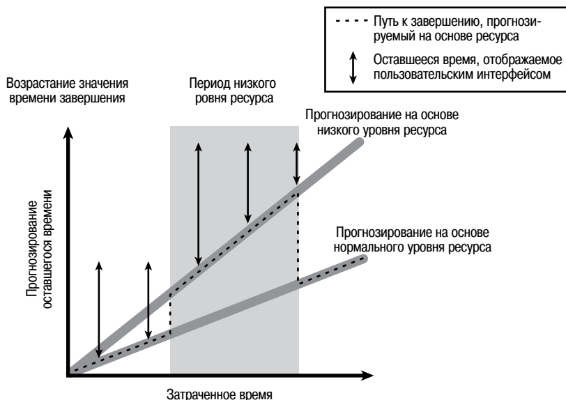
Рис. 6.6. Эта схема иллюстрирует явление флуктуации времени. При нормальной доступности ресурса прогнозируемое оставшееся время будет продолжать уменьшаться. Однако, если ресурсы вдруг становятся ограниченными (например, когда начинает функционировать другой процесс), время завершения пересчитывается и прогнозируемое оставшееся время внезапно возрастает. То, что пользователь видит в результате, — это флуктуации оценки оставшегося времени
