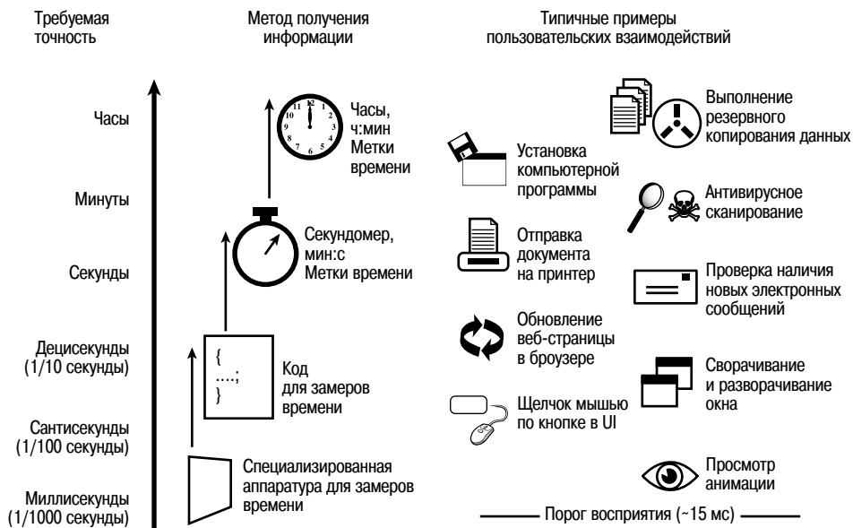
Рис. 9.5. Требуемая точность и методы получения данных для некоторых характерных видов пользовательского взаимодействия. Прямой пользовательский ввод, например нажатия клавиши, перемещения мыши, щелчки мышью и использование сенсорного экрана, обычно требует точности до децисекунд. Более длительные взаимодействия, например установка приложения, конечно, не потребуют того же уровня точности
