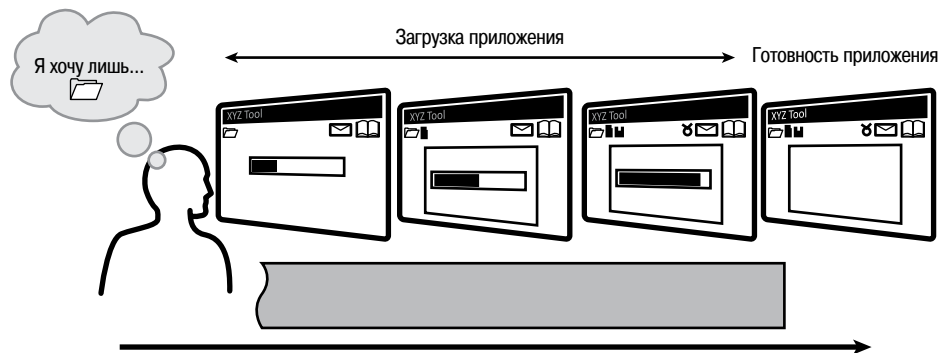
Рис. 11.15. Показанное здесь приложение загружает компоненты, после чего переходит в состояние полной готовности. Это раздражает тех пользователей, которые в действительности хотят выполнить простую задачу, но для получения возможности работать с приложением вынуждены ждать его полной загрузки
