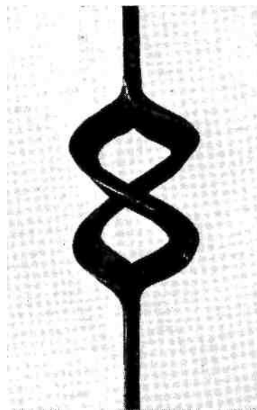
Рис. 263. Шишка из просеченной заготовки
