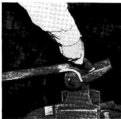
Рис. 268. Отгибание рассеченной заготовки
