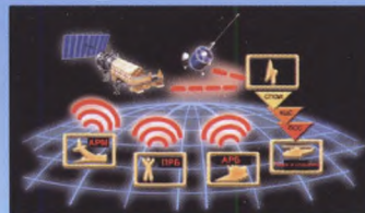
Схема работы системы КОСПАС-САРСАТ
