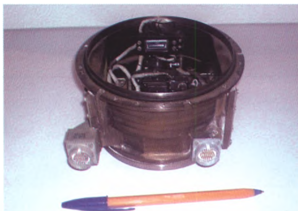
Спектроделительный блок с приемниками ПЗС многозонального сканирующего устройства МСУ-Э (ЗА098). Служит для разделения светового потока на три спектральных диапазона. Год разработки – 1977
