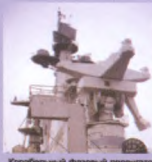
Корабельный фазовый телеметрический радиопередатчик головных частей ракет для измерения их траекторий. Работает в составе корабельной системы «Зефир А». Разработан в 1964 г.
