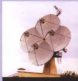
Антенна Б-529 «Ромашка». Со времени разработки в 1971 г. она является основной антенной телеметрических систем, разрабатываемых предприятием отрасли. Зеркальная система состоит из четырех зеркал диаметром 6 м каждое.
