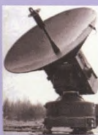
Антенна первой системы радионавигационного телеуправления ракетой БК71. Диаметр зеркала 1 м, длина волны 3 см. Точность наведения 0,1". Разработана в 1957 г.
