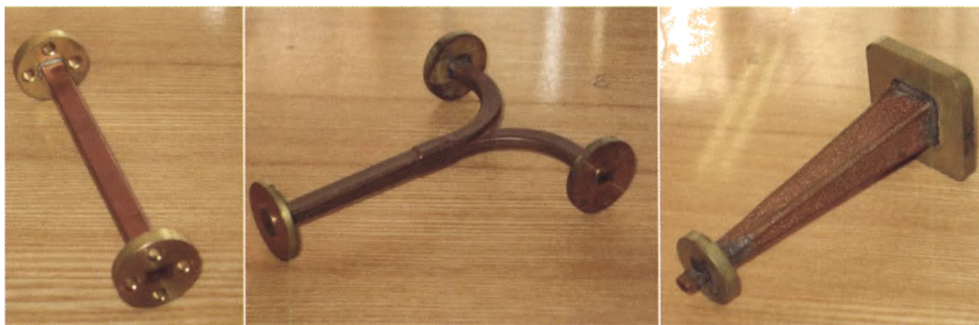
Волноводные устройства КВЧ-диапазона, изготовленные методом гальванопластики. Годы изготовления 1982–1984
