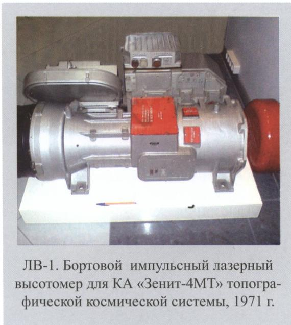
ЛВ-1. Бортовой импульсный лазерный высотомер для КА «Зенит-4МТ» топографической космической системы, 1971 г.
