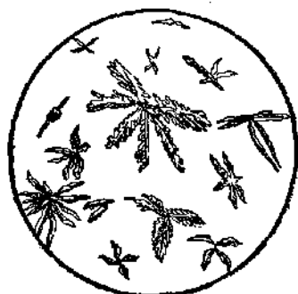
Рис. 22. Кристаллы \text{MgNH}_4\text{PO}_4 \cdot 6\text{H}_2\text{O} , образующиеся при быстрой кристаллизации
