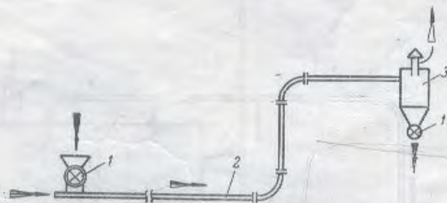
Фиг. 6. Нагнетательная установка среднего давления. Тип II:
