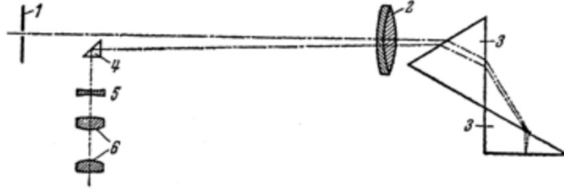
Рис. 12. Оптическая схема автоколлимационного стилоскопа.
