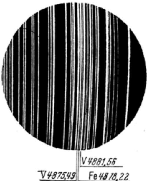
Рис. 2. Пример картины одной из областей спектра стали, видимой в стилоскопе.
