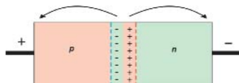
Рис 94. Прямое включение р-n перехода
