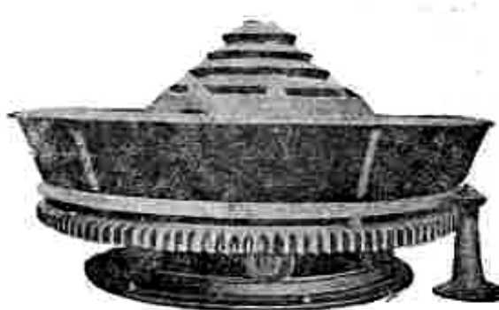
Рис. 83. Механическая решетка Тиссена.
