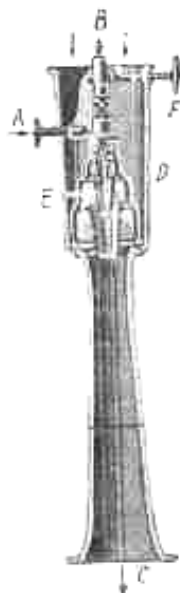
Рис. 325. Пароструйный инжектор типа Ледвард A — труба, подводящая пар, B — засос воздуха, C — диффузор, D — корпус инжектора, E — сопла, F — ручной маховичок.
