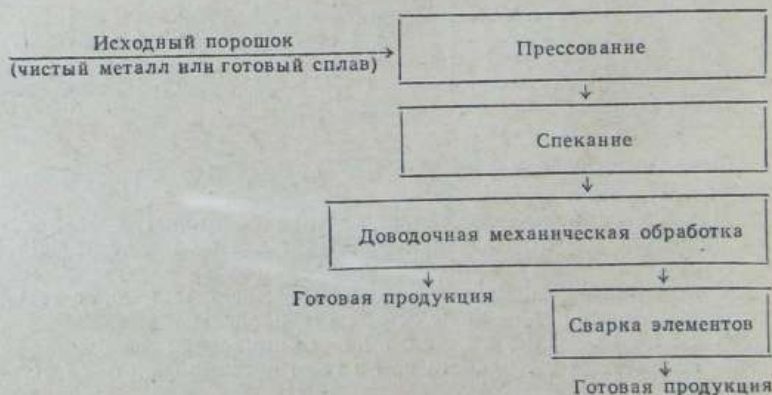
Рис. 19. Технологическая схема изготовления фильтров методом прессования
