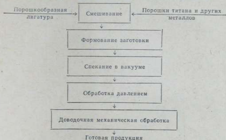
Рис. 30. Технологическая схема изготовления спеченных изделий из порошков сплавов
