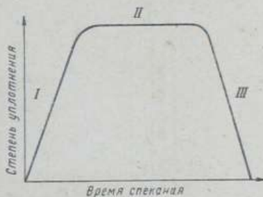
Рис. 9. График процесса спекания I, II, III — стадии спекания
