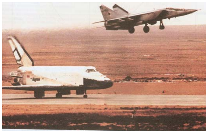
Рис. 1.9. Сравнение носовых обтекателей «Бурана» и сверхзвукового истребителя МИГ-25
