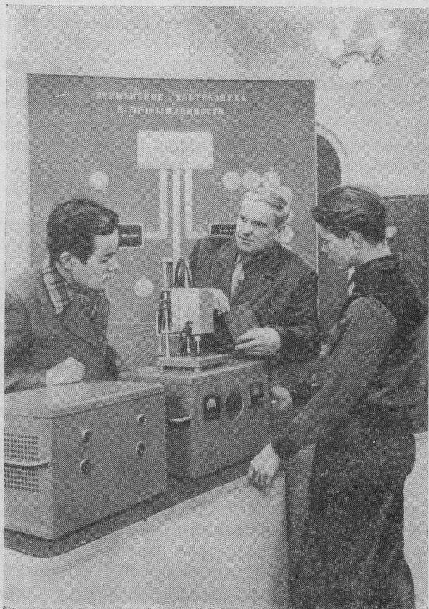
В отделе основ технологии машиностроения. У ультразвуковой установки для обработки твердых и хрупких материалов.
