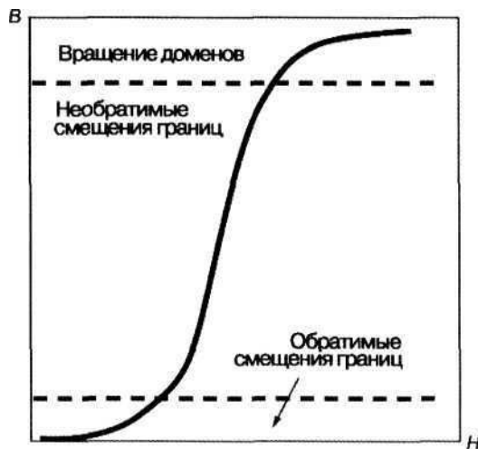
Рис. 4.4.3. Кривая намагничивания и доминирующие процессы на разных ее участках
