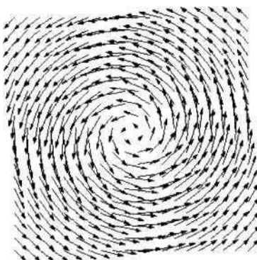
Рис.4.11.11. Картина векторного поля плотности вихревого тока от катушки Рис.4.11.9 в слое проводящей среды на глубине 3 см
