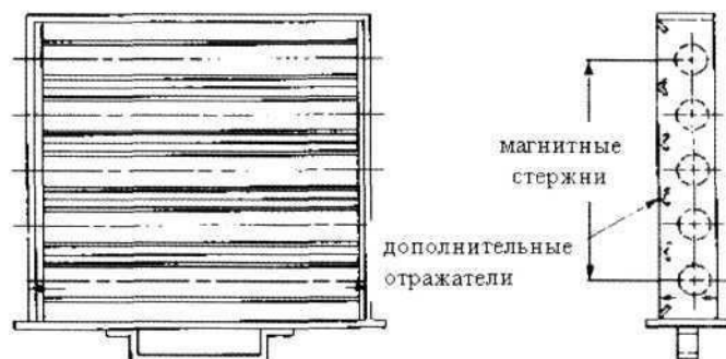
Рис. 6.3.7. Схема магнитной сепарационной решетки
