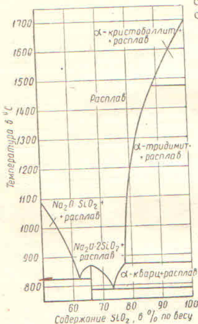
Фиг. 16. Диаграмма плавкости системы \text{SiO}_2 - \text{Na}_2\text{O} .
