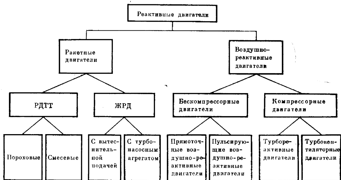
Рис. 4. Классификация воздушно-реактивных и ракетных двигателей
