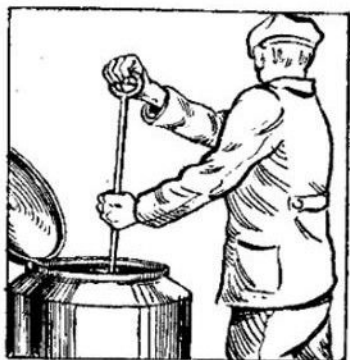
Фиг. 109. Шуровка топлива в газогенераторе.
