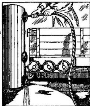
Фиг. 118. Промывка кожухов очистителей газустановки при помощи брандспойта:
