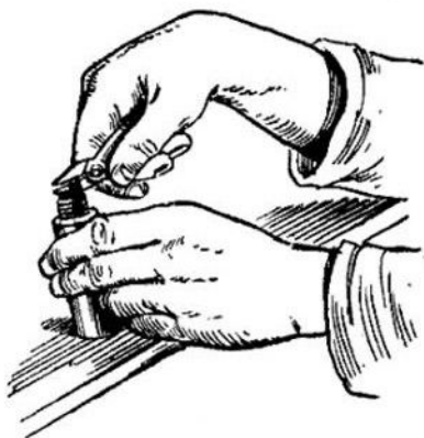
Фиг. 119. Регулировка боковых электродов запальной свечи.
