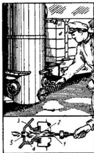
Фиг. 111. Разжиг газогенератора факелом (внизу показано отдельно подсасывание языков пламени в топливник при разжиге, топливник здесь показан в разрезе):
