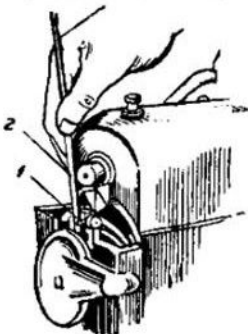
Фиг. 121. Проверка зазора между контактами прерывателя магнето:
