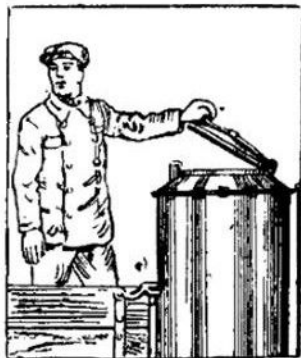
Фиг. 126. Рекомендуемое положение рабочего при открытии крышки загрузочного люка бункера; во избежание отравления и ожогов голова повернута в сторону.
