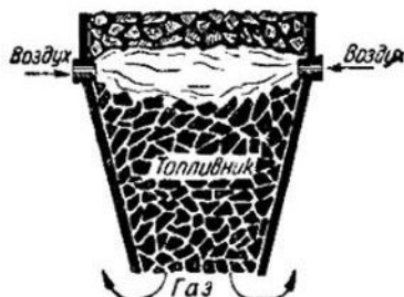
Фиг. 30. Схема конического топливника с максимальным сужением внизу.
