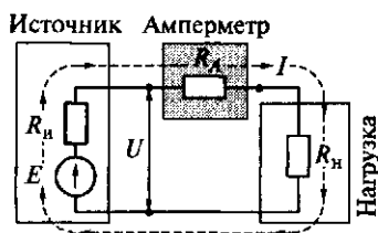
Рис. 1.15. Влияние амперметра на ток в цепи
