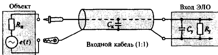
Рис. 4.21. Подключение входного кабеля без деления (1:1)
