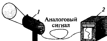
Рис. 8.21. Аналоговая регистрация температуры:
