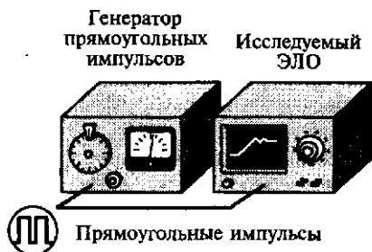
Рис. 4.20. Экспериментальное определение времени нарастания и времени установления канала Y
