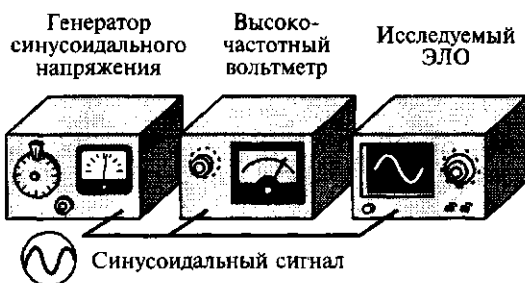
Рис. 4.17. Экспериментальное определение АЧХ канала УЭЛО
