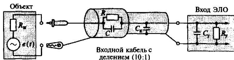
Рис. 4.22. Подключение входного кабеля с делением
