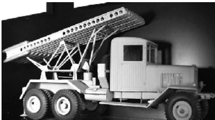
Рис. 62. Пусковая ракетная установка на автомобильном шасси БМ-13 – легендарная «Катюша»
