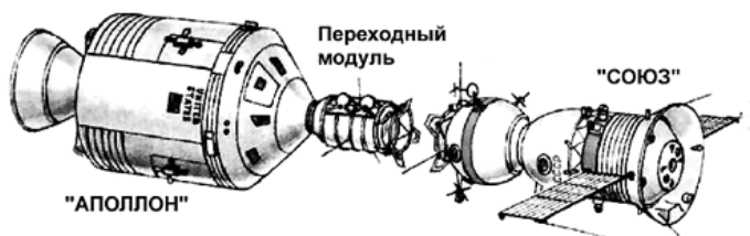
Рис. 114. Схема стыковки космических кораблей «Аполлон» (США) и «Союз» (СССР)
