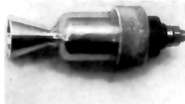
Рис. 49. Первый в мире электроракетный двигатель конструкции В.П. Глушко (1930-е гг.)
