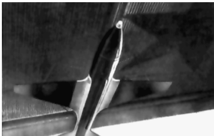
Рис. 64. Крылатая ракета 301 конструкции С.П. Королева, подвешенная под крылом тяжелого бомбардировщика
