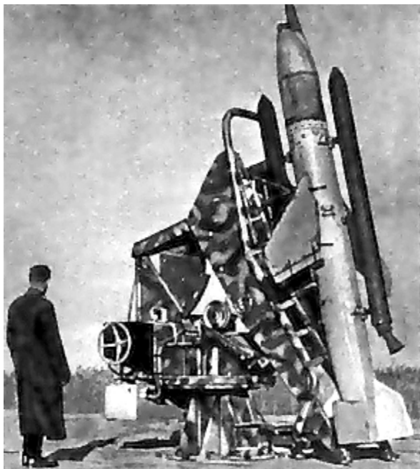
Рис. 74. Зенитная ракета «Шмиттерлинг» на пусковой установке (Германия, 1945 г.)
