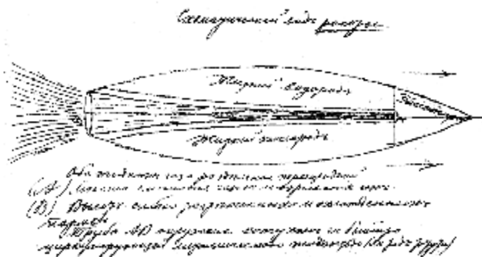
Рис. 21 Схема жидкостной ракеты. Рисунок К.Э. Циолковского (1903 г.)
