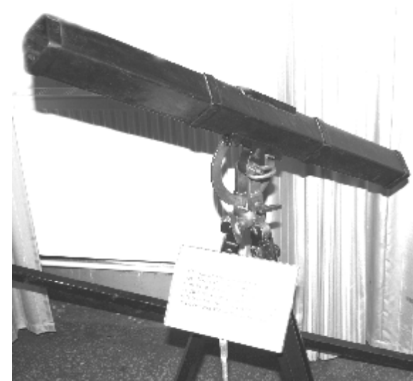
Рис. 16. Универсальный пусковой станок конструкции К.И. Константинова
