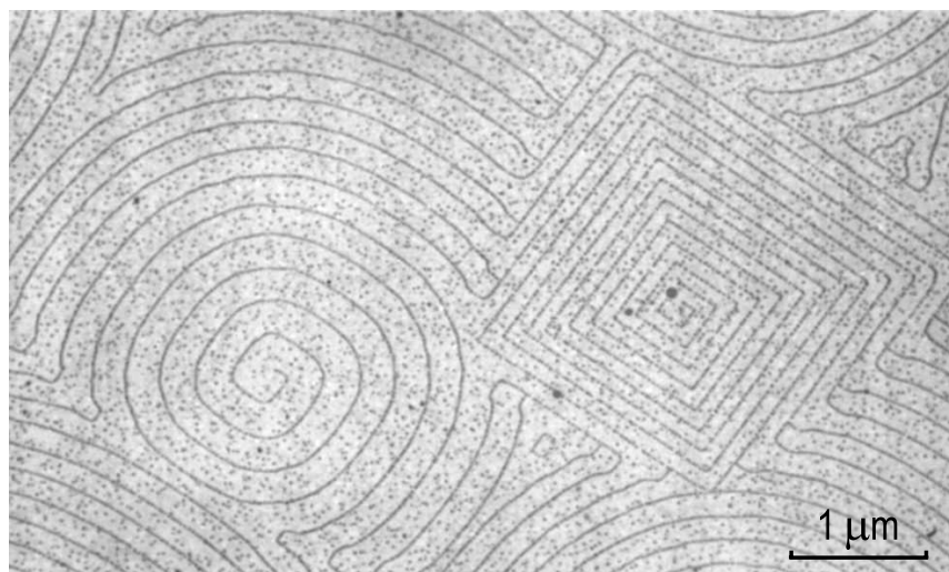
Рис. 9.20. Структура ступеней в точках выхода винтовых дислокаций, полученных сублимацией кристалла \text{NaCl} при 400^\circ\text{C} в течение 90 мин. в вакууме [9.12]
