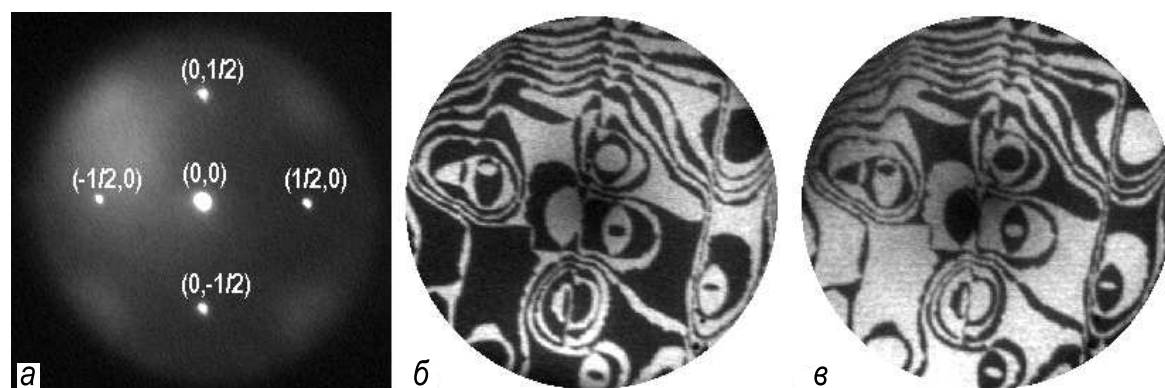
Рис. 6.12. а – Картина ДМЭ чистой поверхности \text{Si}(100)2\times 1 . б – Темнопольное изображение поверхности в микроскопе медленных электронов в свете рефлексов (1/2,0) или (-1/2,0) . в – Та же поверхность, что и на рис. б в свете рефлексов (0,1/2) или (0,-1/2) . Размер поля изображения 5 мкм [6.8]
