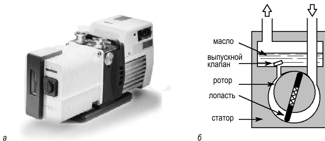
Рис. 2.3. а – Фотография ротационного лопастного насоса фирмы «Alcatel»; б – Схематическая диаграмма, иллюстрирующая его принцип действия. Ротор вращается по часовой стрелке
