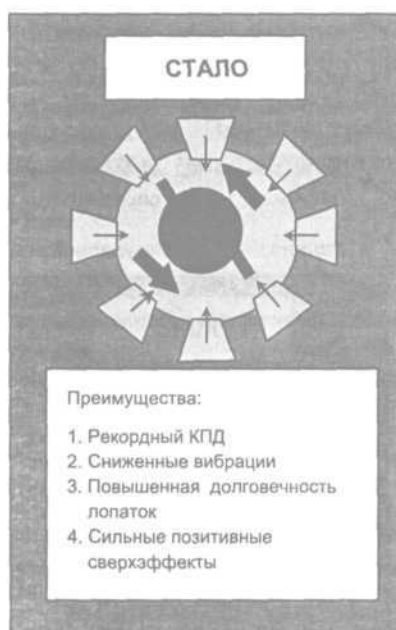
Рис. 12.16. Схема новой турбины
