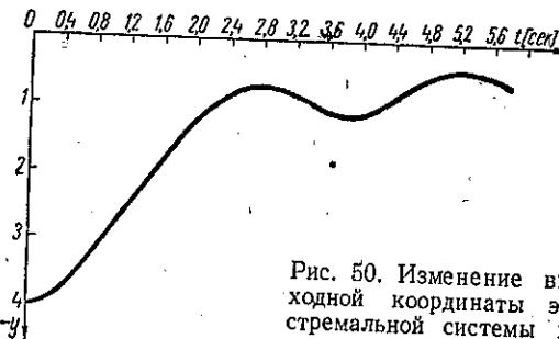
Рис. 50. Изменение выходной координаты экстремальной системы во времени
