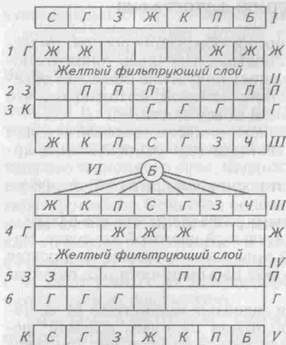
Рис. 4.8. Схема цветного фотоизображения:
