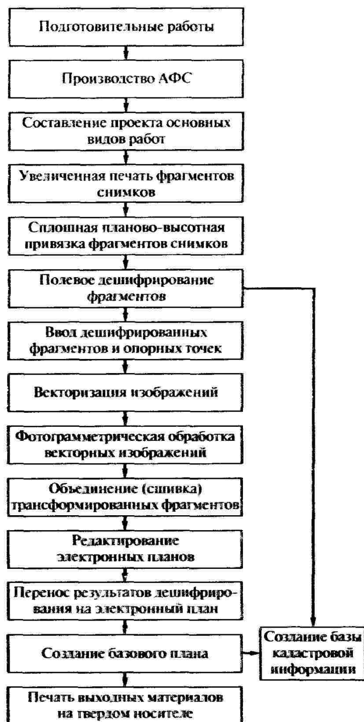
Рис. 17.1. Технологическая схема создания базового плана на основе фотограмметрической обработки одиночного снимка (вариант 1)
