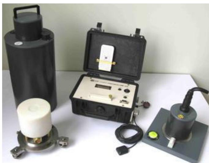
Рис. 3.13. Трёхкомпонентный феррозондовый магнитометр LEMI-018. [www.isr.lviv.ua]
