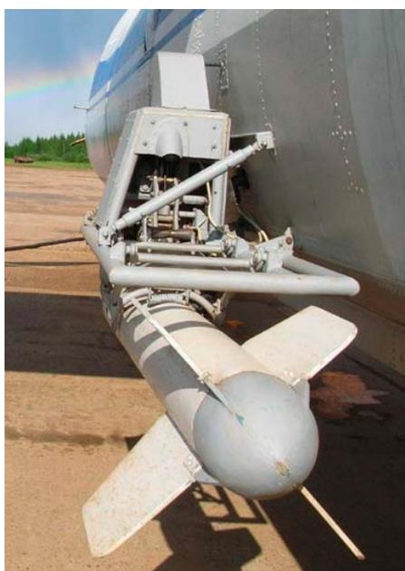
Рис.5.5. Выпускное оборудование (порт) и гондола. [aerogeo.ru].
