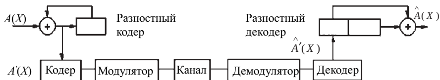
Рис. 6.2. Способ передачи по каналу с неоднозначностью с внешним относительным кодированием
