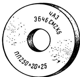
Рис. 48. Маркировка (технический паспорт) шлифовального круга: ЧАЗ — завод-изготовитель (Челябинский абразивный завод); ЭБ — абразивный материал (электрокорунд белый); 46 — зернистость; СМ2 — твердость; К — связка (керамическая); 6 — структура; ПП — форма круга (плоский профиль); 250 — наружный диаметр; 20 — высота круга; 25 — диаметр отверстия.
