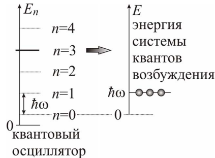
Рис. 7.2. Нахождение квантового осциллятора на n -м уровне (на рис. n = 3 ) возбуждения с энергией E_n = \hbar \omega (n + 1/2) соответствует рождению n квантов, каждый из которых имеет энергию \hbar \omega .
