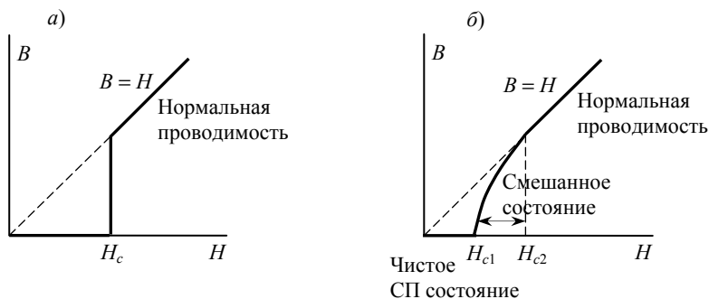
Рис. VI.24. Кривые намагничения сверхпроводника первого ( а ) и второго ( б ) рода: H_c , H_{c1} , H_{c2} — критические значения магнитного поля
