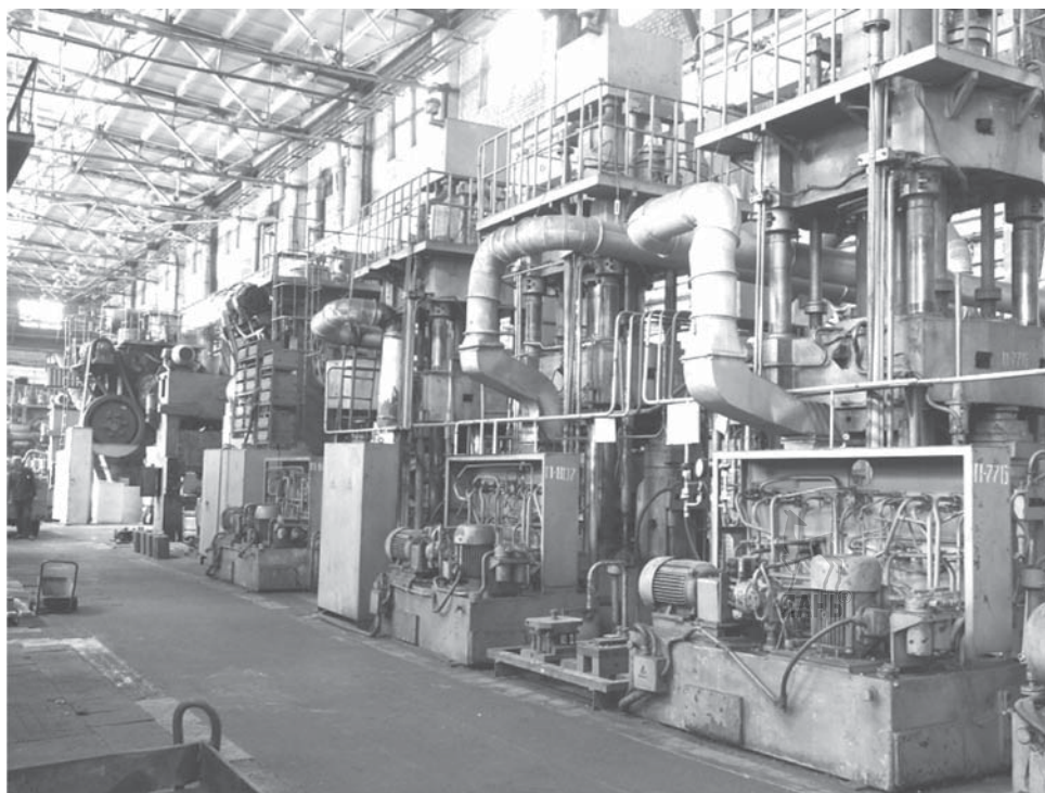
Рис. 10.18. Общий вид участка изотермической штамповки (вид сзади), оснащенного изотермическими установками, выполненными на базе гидравлических прессов с номинальной силой 6,3 МН (630 тс)
