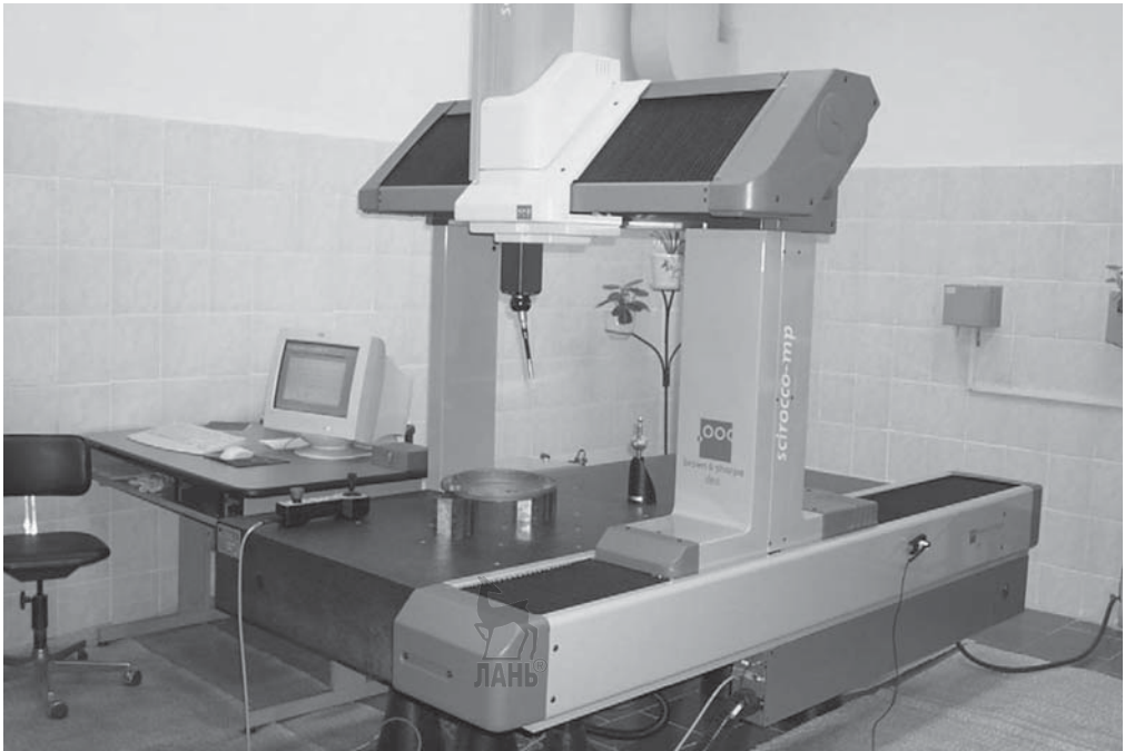
Рис. 12.11. Контактная контрольно-измерительная машина (КИМ)
