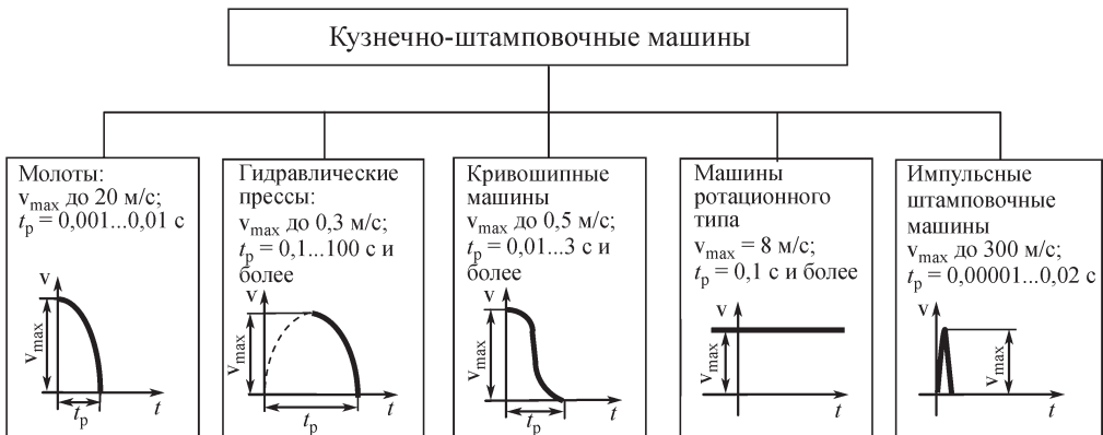
Рис. 7.1. Классификация кузнечно-штамповочных машин
