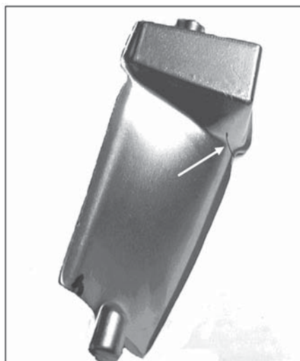
Рис. 13.7. Заготовка лопатки авиационного двигателя с дефектом в виде закова (прострела)
