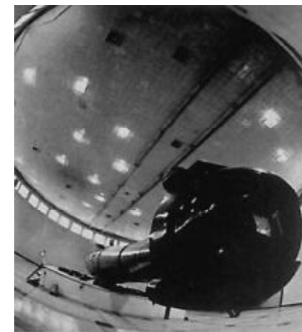
Рис. 130. Центрифуга Ц-18 в Центре подготовки космонавтов
