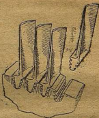
Лопатки газовой турбины.
