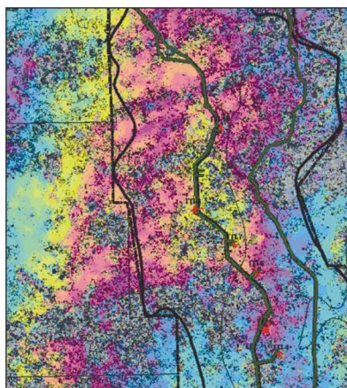
Рисунок 3.3. Пример дифференциальной интерферограммы снимков Уренгойского нефтегазоконденсатного месторождения за 2003–2004 гг., сопоставленной с наземной инфраструктурой
