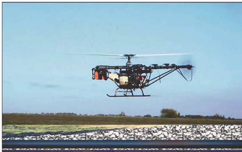
Рисунок 4.36. Использование дрона для геотехнического мониторинга газопровода
