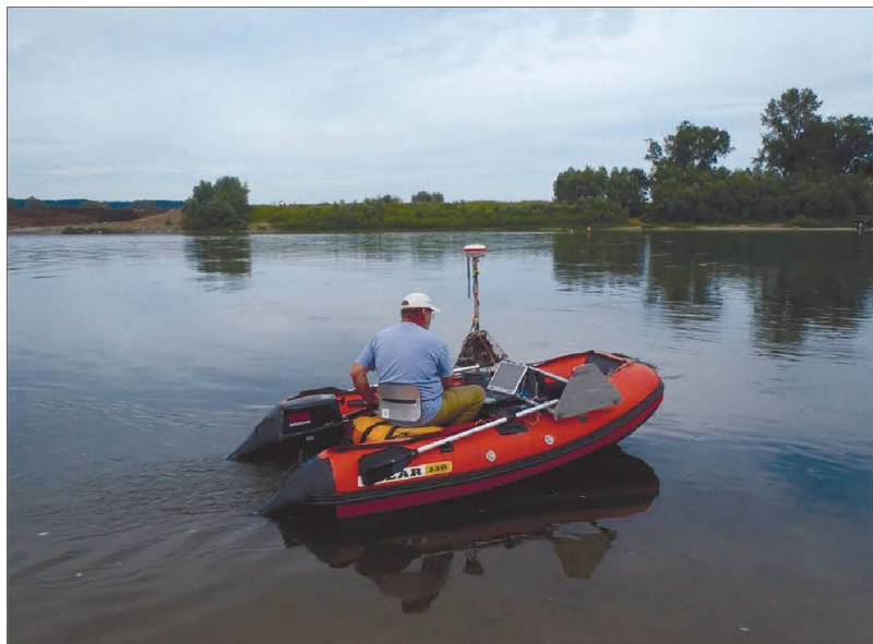
Рисунок 3.16. Лодка с установленным ГНСС приемником и промерным эхолотом
