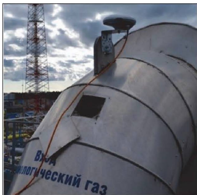
Рисунок 4.18. Внешний вид установленной на точки мониторинга принимающей антенны
