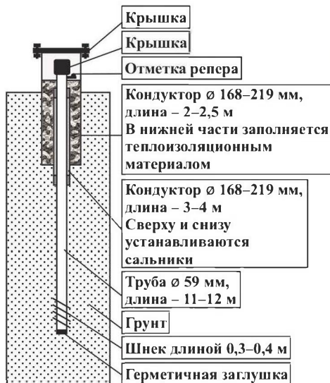
Рисунок 3.19. Глубинный геодезический репер:
