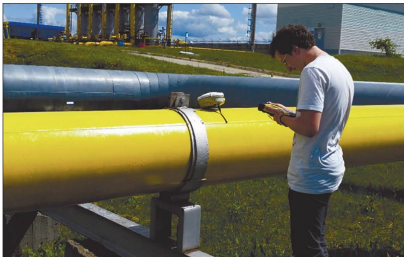
Рисунок 3.12. Измерение координат опорной точки
