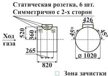
Рисунок 2.16. Расположение датчиков, обеспечивающее контроль возможного изменения НДС
