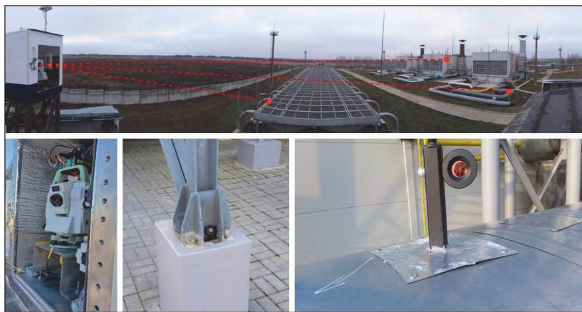
Рисунок 4.17. Внешний вид подсистемы измерения на базе роботизированного тахеометра
