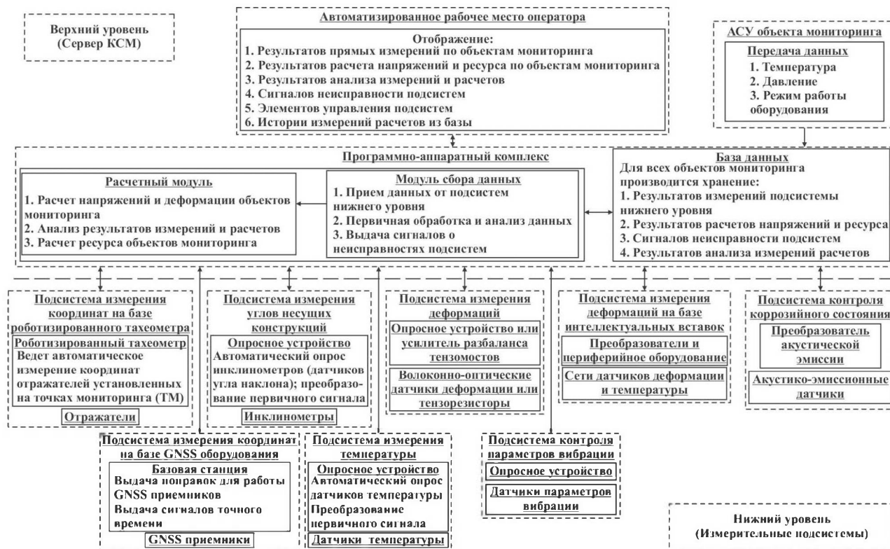
Рисунок 4.16. Структурная схема комплексной системы мониторинга
