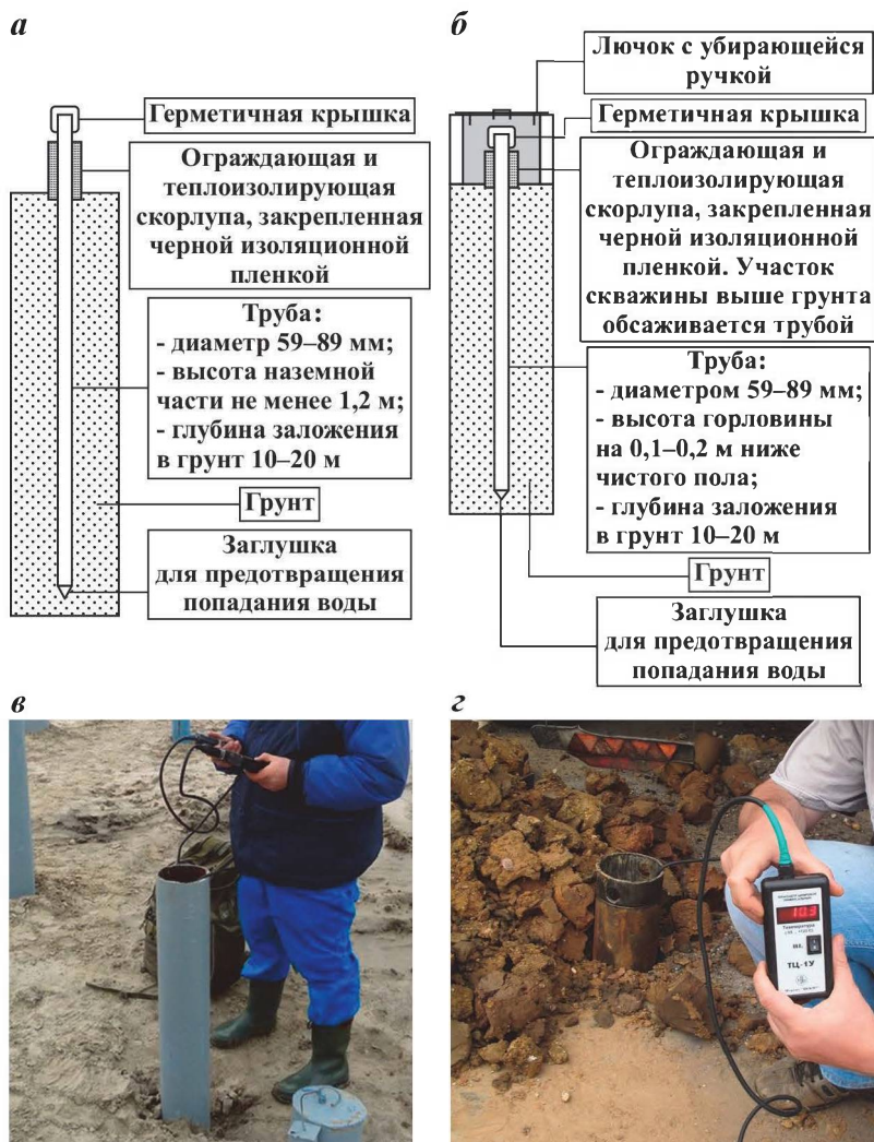
Рисунок 3.22. Термометрическая наблюдательная скважина: а – для установки вне помещений; б – для установки внутри зданий в и г – процесс измерения температуры в скважине
