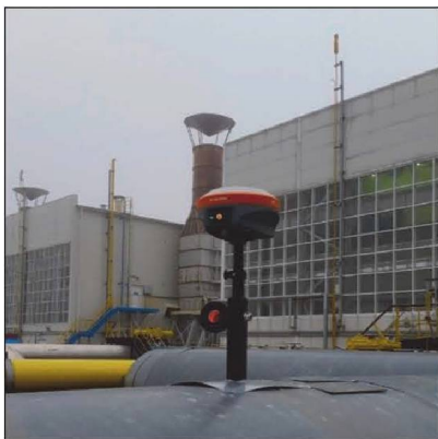
Рисунок 4.18. Внешний вид установленной на точки мониторинга принимающей антенны
