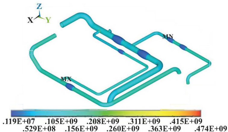
Рисунок 2.10. Распределение эквивалентных напряжений в ТПО ГПА, Па
