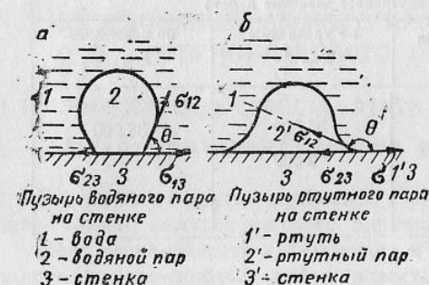
Фиг. 84. Краевой угол смачивания \theta при растекании на границе трех фаз.
