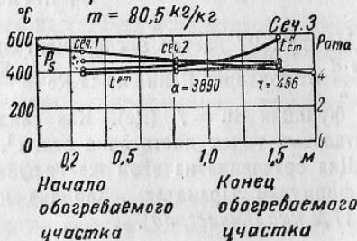
Фиг. 96. Температура и давление ртути по высоте вертикального участка контура с эмульсионной петлей.
