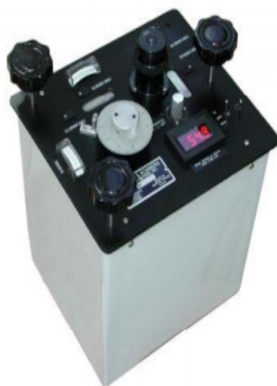
Рис.13. Схема чувствительной системы и внешний вид гравиметра LaCoste & Romberg G/D [12].
