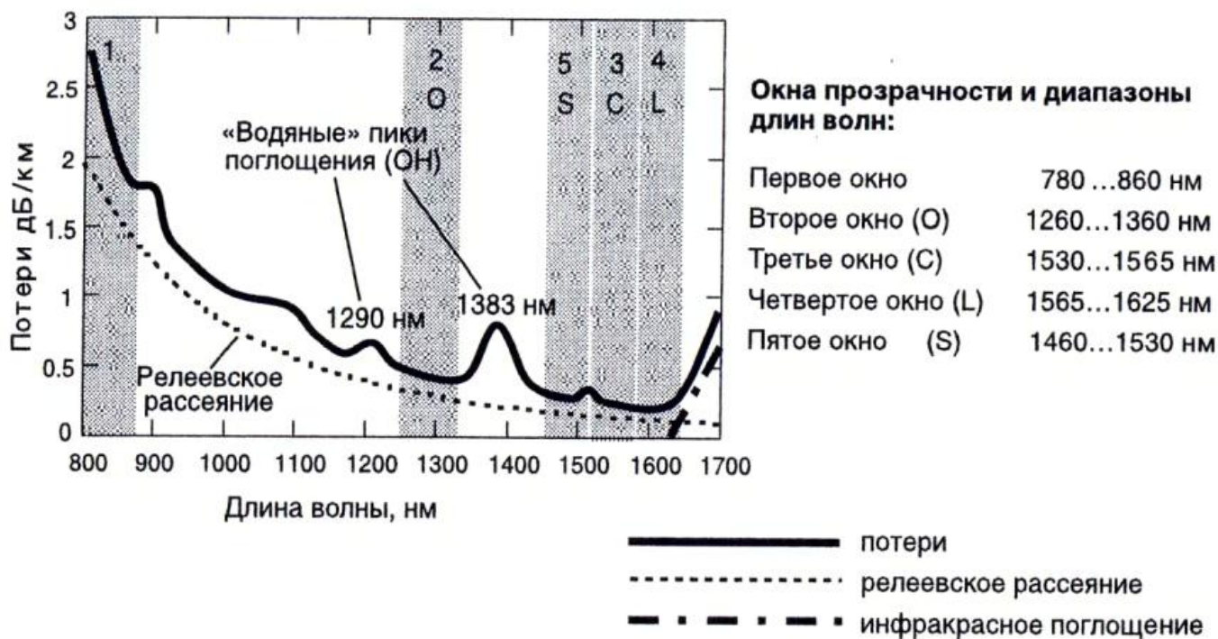
Рис. 1.3. Спектр потерь и положение окон прозрачности в кварцевых волокнах.
