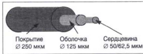
Рис. 1.1. Геометрические параметры одномодовых и многомодовых волокон
