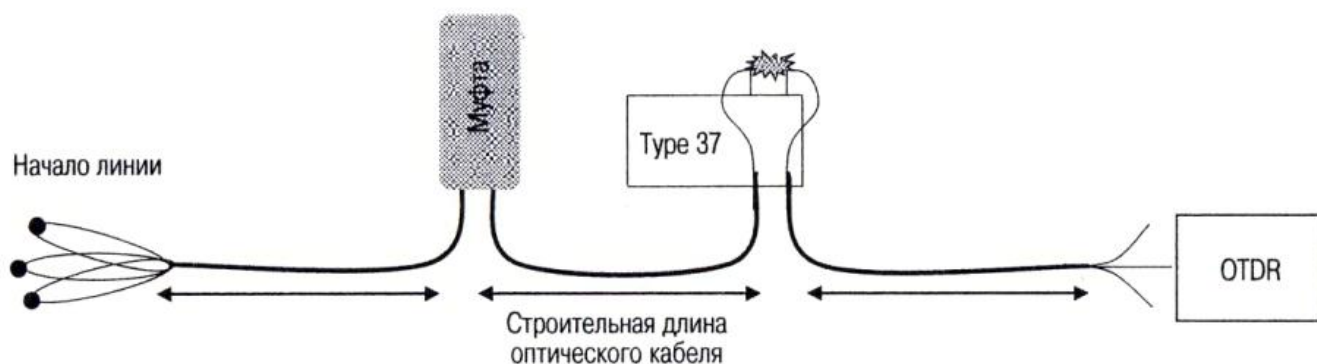
Рис. 3.26. Схема измерения потерь в сростках волокон методом шлейфа
