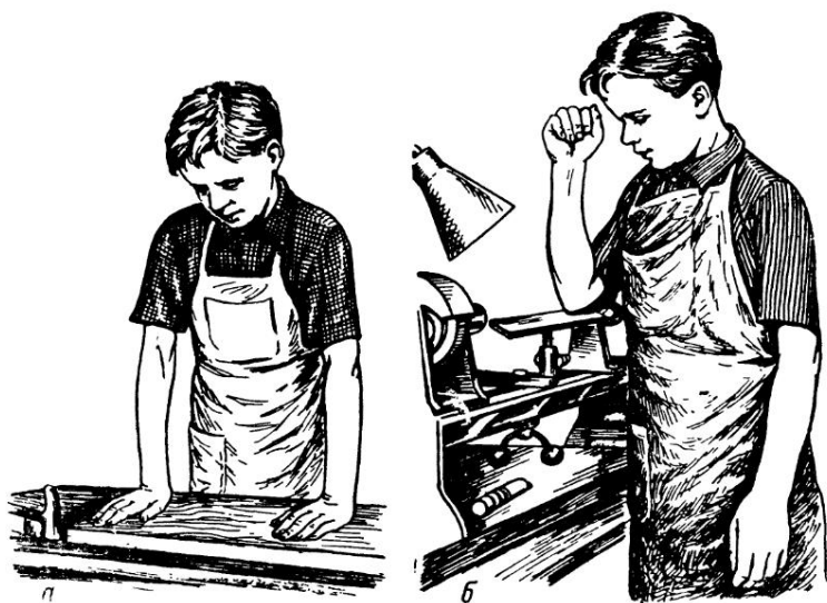
Рис. 30. Проверка высоты верстака (а) и токарного станка (б).
