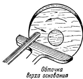
Рис. 117. Настольная лампа (общий вид, детали и приемы обработки).
